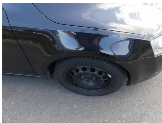
Bild 22: Karosserie / Kotflügel rechts Steinschlag
