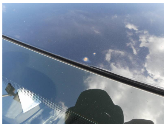
Bild 30: Karosserie / Dach und Dachkante Steinschläge mit Korrosionsansatz,
