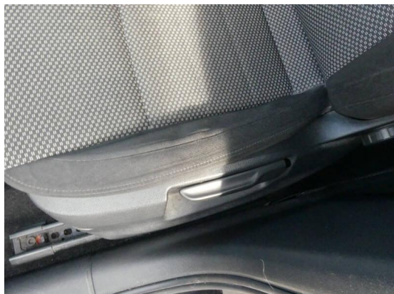
Bild 37: Innenraum / Sitzpolster verschlissen
