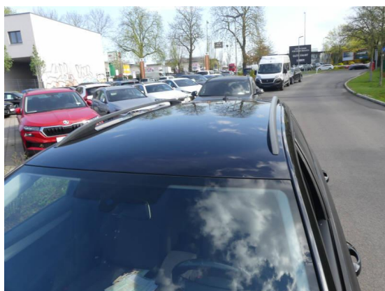
Bild 33: Karosserie / Dach und Dachkante Steinschläge mit Korrosionsansatz,
