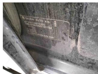
Fahrzeug - Typenschild/Fahrgestellnummer
