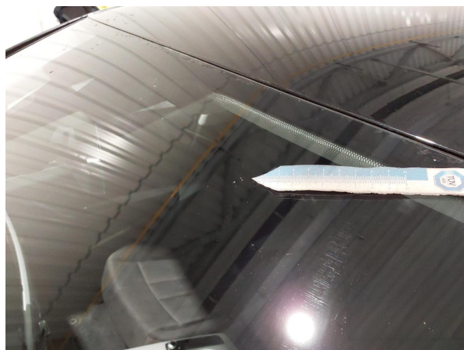
Gebrauchsspur 1: Verglasung: Frontscheibe - Steinschlag - kein Abzug
