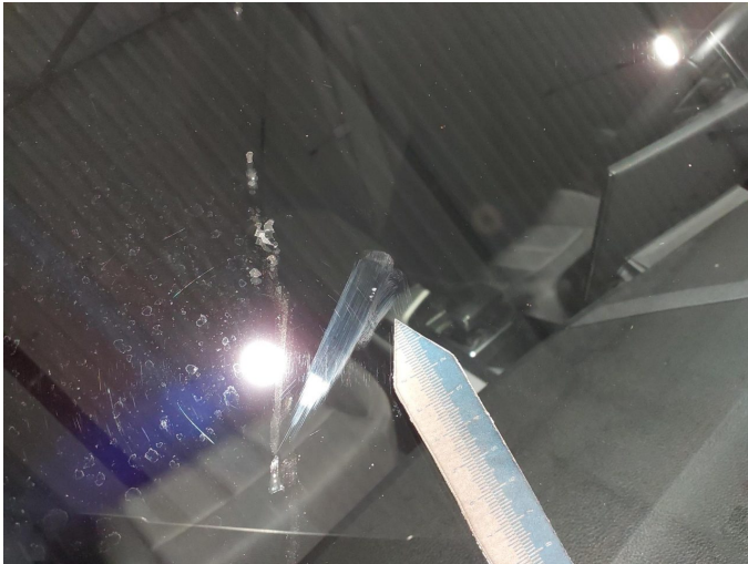
Gebrauchsspur 1: Verglasung: Frontscheibe - Steinschlag - kein Abzug
