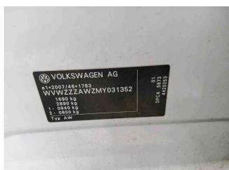
Fahrzeug - Typenschild/Fahrgestellnummer
