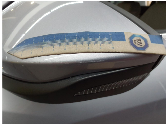
Beschädigung 1: Außenspiegel links: Abdeckkappe - Kratzer - auslegen / polieren
