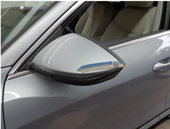
Beschädigung 1: Außenspiegel links: Abdeckkappe - Kratzer - auslegen / polieren
