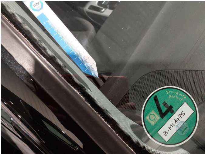
Gebrauchsspur 3: Verglasung: Frontscheibe - Steinschlag - kein Abzug
