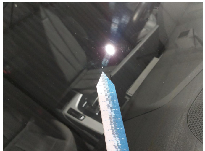
Gebrauchsspur 3: Verglasung: Frontscheibe - Steinschlag - kein Abzug
