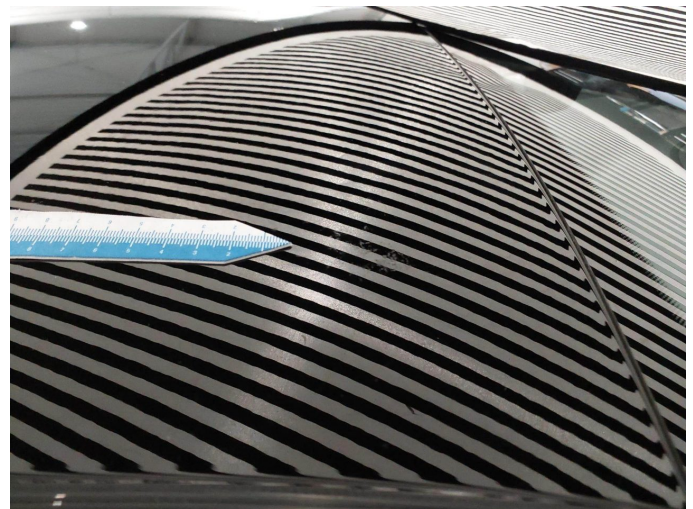
Beschädigung 1: Fahrzeugdach: Dach - beschädigt - auslegen / polieren
