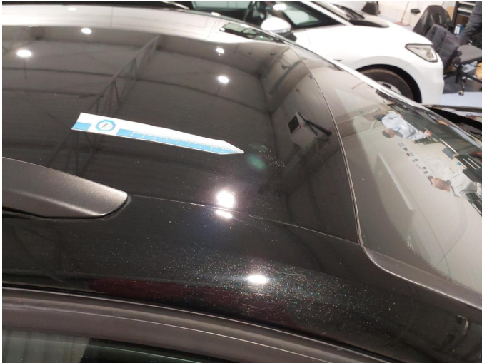
Beschädigung 1: Fahrzeugdach: Dach - beschädigt - auslegen / polieren
