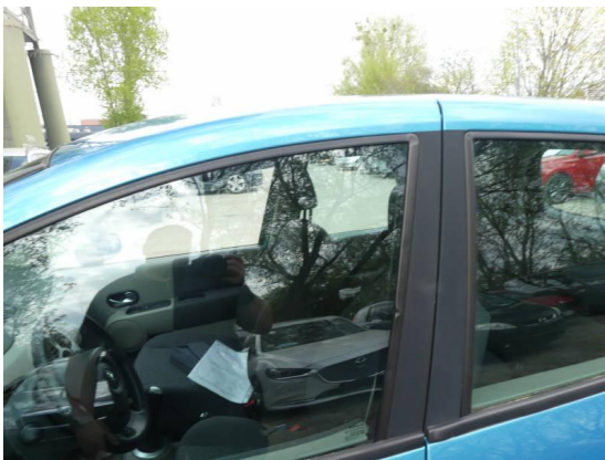
Bild 39: Karosserie / Fensterrahmen Tür vorne links verzogen
