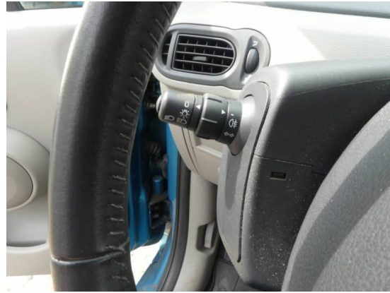
Bild 32: Technik / Lichtschalter Wackelkontakt
