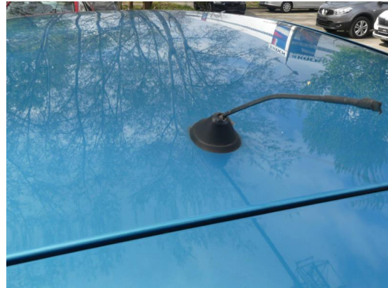
Bild 8: Technik / Antennenstab und Fuß defekt
