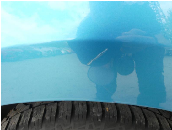
Bild 15: Karosserie / Seitenwand rechts deformiert und zerkratzt
