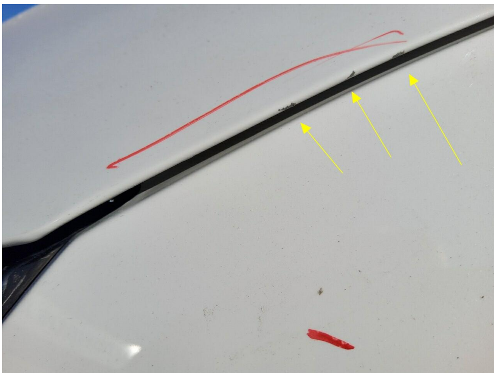
Bild 14 : Motorhaube hat Steinschläge, austupfen und polieren
