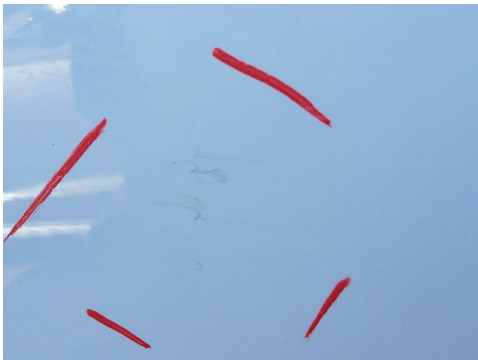
Bild 12 : Tür hinten rechts verkratzt
