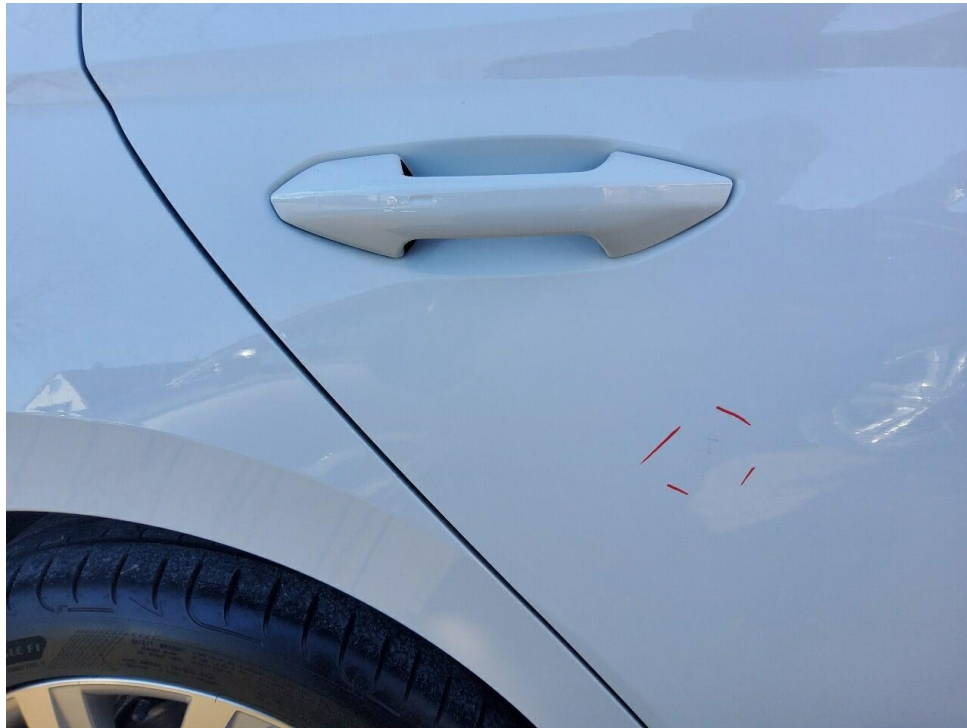
Bild 11 : Tür hinten rechts verkratzt
