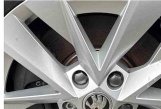
2 - Brems Scheiben hinten - Korrosion - Ersetzen
