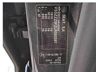
Fahrzeug - Typenschild/Fahrgestellnummer
