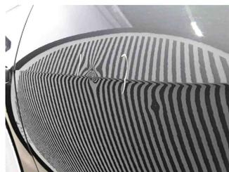
4 - Tür vorne rechts - Delle(n) und Kratzer - Instandsetzen + lackieren
