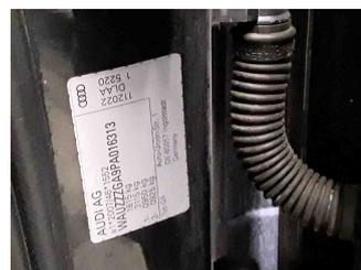
Fahrzeug - Typenschild/Fahrgestellnummer
