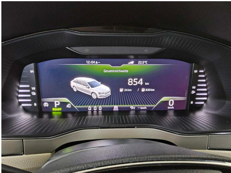
Bild 9 : Kombiinstrument bei laufendem Motor
