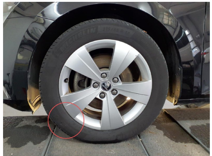
Beschädigung 10: Rad/Reifen: Reifen vorn links - beschädigt - erneuern
