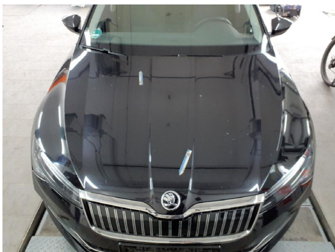
Beschädigung 5: Motorhaube: Motorhaube - Delle(n) - sanft instandsetzen
