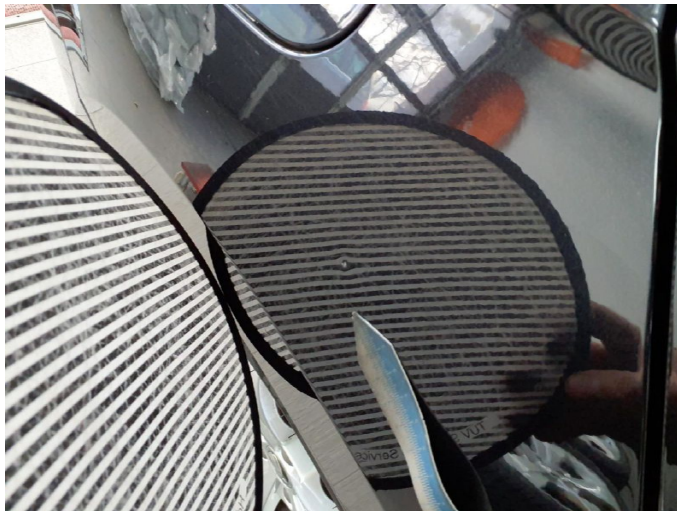
Beschädigung 8: Seitenwand rechts: Seitenwand (Inklusive auslegen polieren) - Delle / Lackschaden - sanft instandsetzen
