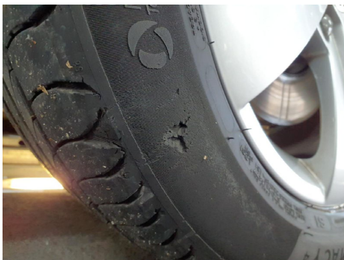
Beschädigung 10: Rad/Reifen: Reifen vorn links - beschädigt - erneuern
