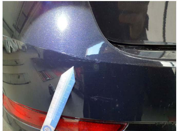
Beschädigung 11: Stossfänger hinten: Stossfänger hinten - Kratzer - lackieren
