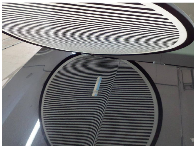
Beschädigung 5: Motorhaube: Motorhaube - Delle(n) - sanft instandsetzen
