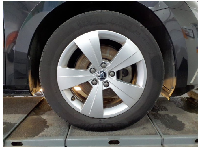
Gebrauchsspur 1: Bremsanlage: Bremsscheiben und Beläge vorn (Oberflächlich ohne Riefenbildung) - Korrosion - kein Abzug
