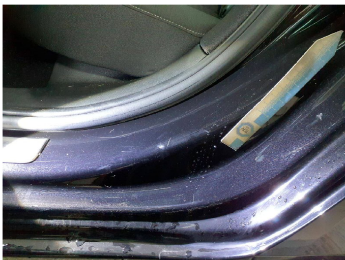
Beschädigung 7: Seitenwand links: Einstieg - Kratzer - Smart Repair
