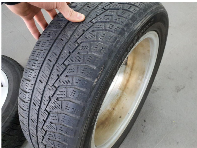
Beschädigung 1: 2.Radsatz: 2 Reifen (1 Reifen platt. Profiltiefen stark ungleichmäßig) - erneuern
