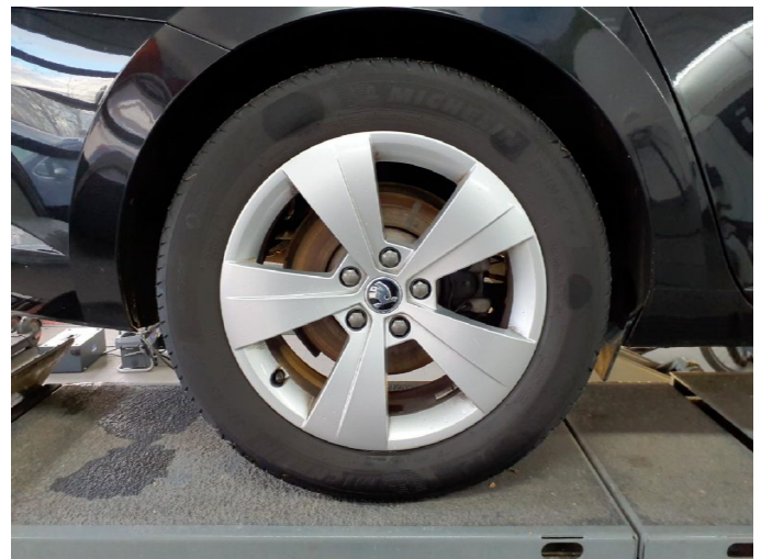
Gebrauchsspur 2: Bremsanlage: Bremsscheiben und Beläge hinten (Oberflächlich ohne Riefenbildung) - Korrosion - kein Abzug
