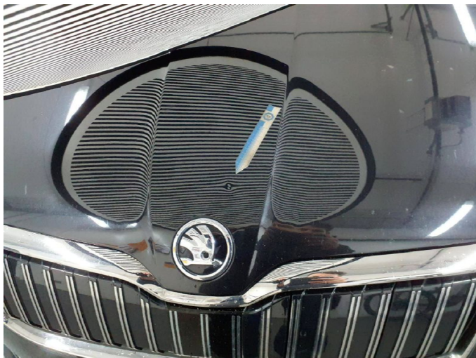
Beschädigung 5: Motorhaube: Motorhaube - Delle(n) - sanft instandsetzen
