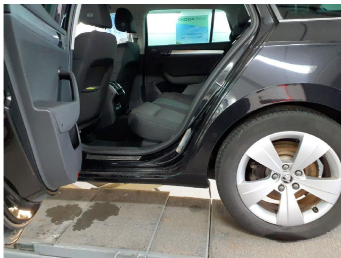
Beschädigung 7: Seitenwand links: Einstieg - Kratzer - Smart Repair
