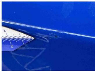
6 - Kotflügel hinten rechts - Delle(n) - Spotrepair
