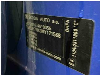
Fahrzeug - Typenschild/Fahrgestellnummer
