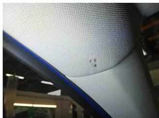
2 - Seitenwand hinten links - Delle(n) - Kaltdrücken
