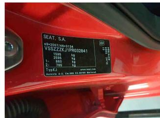
Fahrzeug - Typenschild/Fahrgestellnummer
