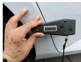
Lackstärke Seitenwand hinten rechts
