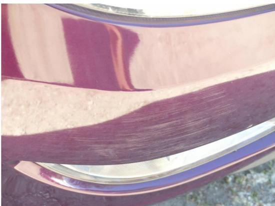
Bild 41: Karosserie / Stoßfänger vorn zerkratzt
