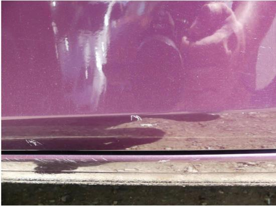
Bild 49: Karosserie / Tür vorne links Dellen und zerkratzt
