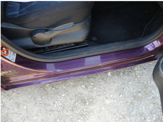
Bild 27: Karosserie / Einstieg vorne rechts zerkratzt
