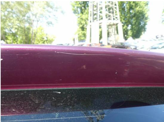
Bild 17: Karosserie / Heckklappe zerkratzt
