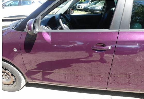
Bild 50: Karosserie / Tür vorne links Dellen und zerkratzt
