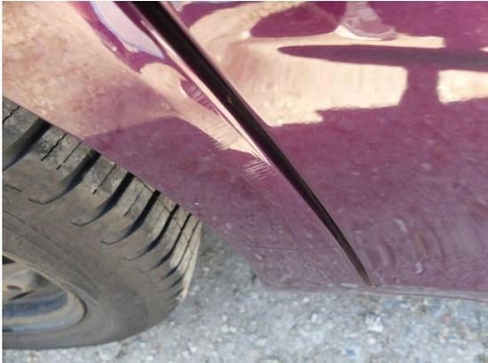
Bild 19: Karosserie / Seitenteil rechts Kratzer
