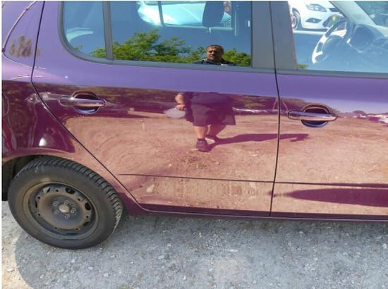
Bild 25: Karosserie / Tür hinten rechts Dellen und Kratzer
