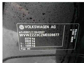
Fahrzeug - Typenschild/Fahrgestellnummer
