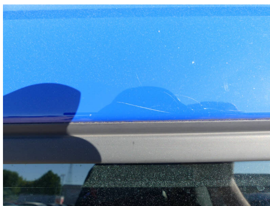
Bild 16: Karosserie / Dachholm rechts Kratzer
