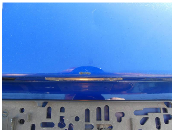
Bild 8: Karosserie / Heckklappe Delle und zerkratzt
