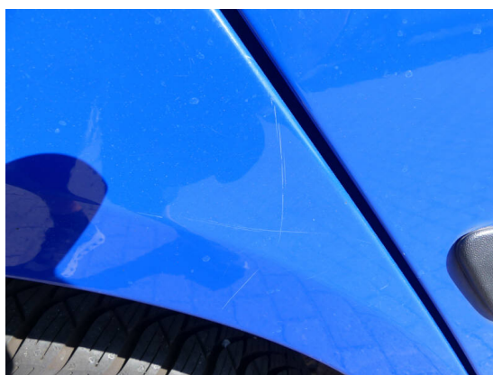
Bild 12: Karosserie / Seitenteil rechts leicht deformiert und zerkratzt
