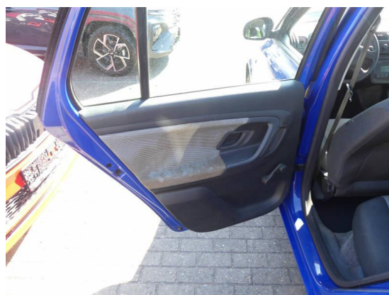
Bild 42: Innenraum / Türverkleidung hinten links fleckig
