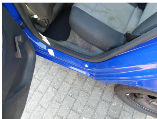
Bild 40: Karosserie / Einstieg hinten links zerkratzt mit Korrosion
