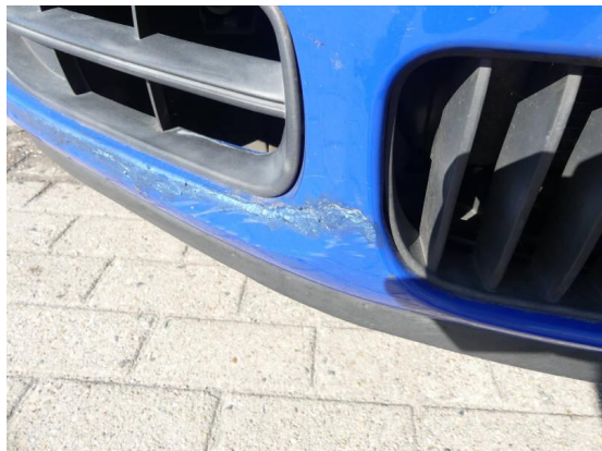
Bild 1: Karosserie / Stoßfänger vorn gebrochen und zerkratzt
