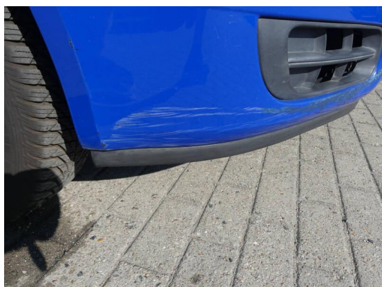
Bild 3: Karosserie / Stoßfänger vorn gebrochen und zerkratzt
