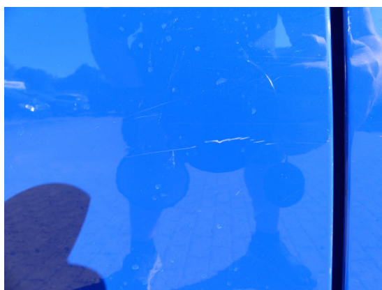
Bild 18: Karosserie / Tür hinten rechts zerkratzt und Korrosion
