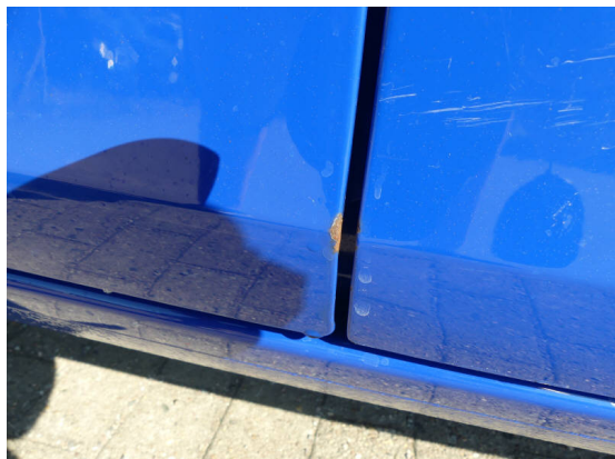
Bild 19: Karosserie / Tür hinten rechts zerkratzt und Korrosion
