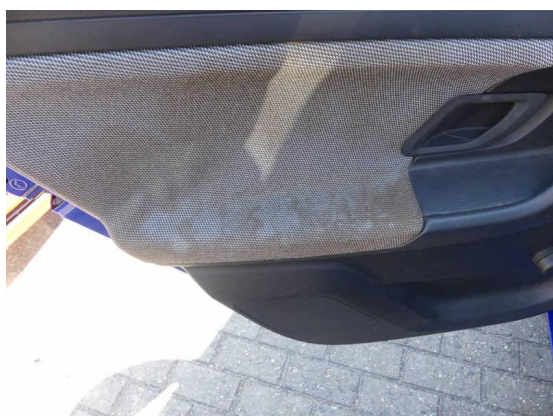
Bild 41: Innenraum / Türverkleidung hinten links fleckig
