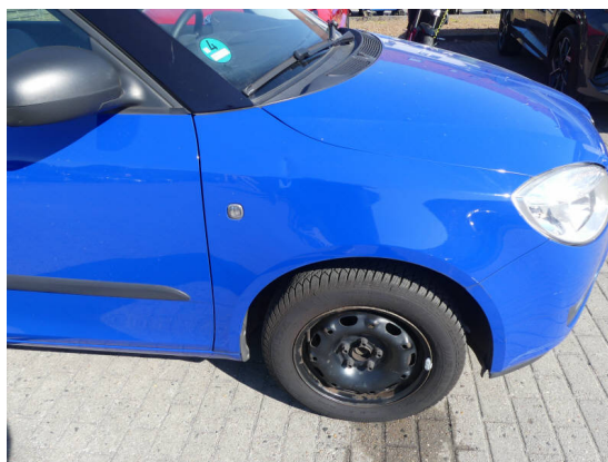
Bild 26: Karosserie / Kotflügel rechts deformiert und zerkratzt
