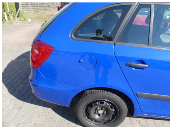
Bild 13: Karosserie / Seitenteil rechts leicht deformiert und zerkratzt
