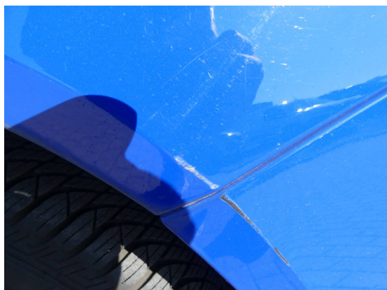
Bild 25: Karosserie / Kotflügel rechts deformiert und zerkratzt
