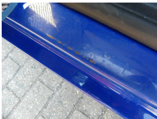
Bild 39: Karosserie / Einstieg hinten links zerkratzt mit Korrosion
