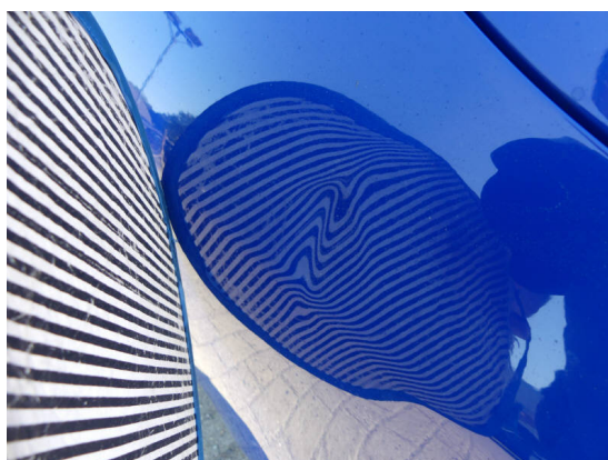
Bild 24: Karosserie / Kotflügel rechts deformiert und zerkratzt
