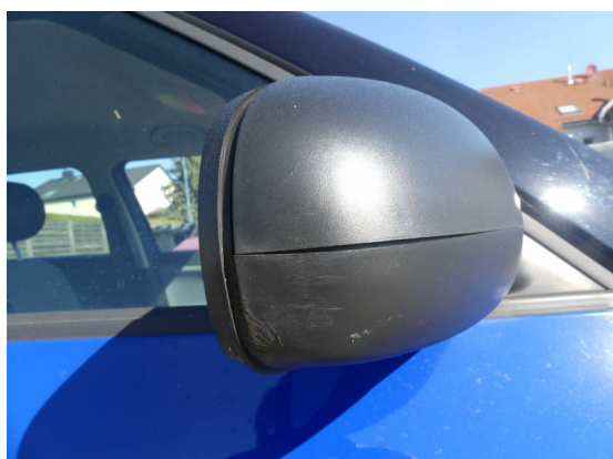
Bild 23: Karosserie / Spiegelgehäuse rechts zerkratzt
