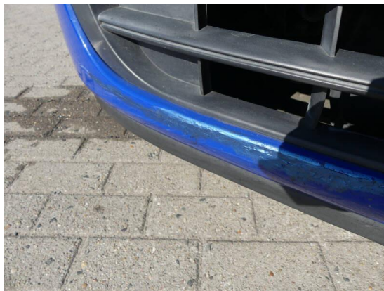
Bild 2: Karosserie / Stoßfänger vorn gebrochen und zerkratzt
