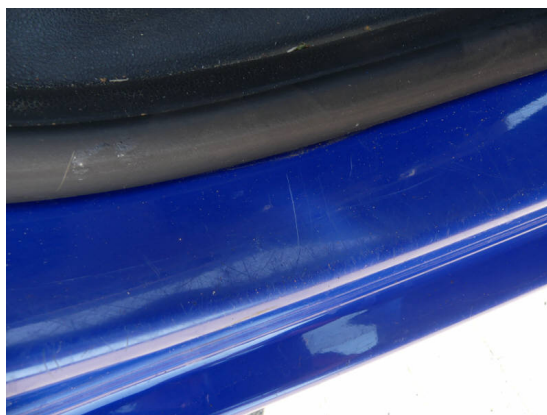
Bild 14: Karosserie / Einstieg hinten rechts zerkratzt
