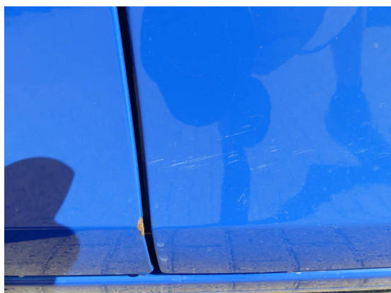
Bild 21: Karosserie / Tür vorne rechts Kratzer
