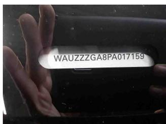
Fahrzeug - Typenschild/Fahrgestellnummer
