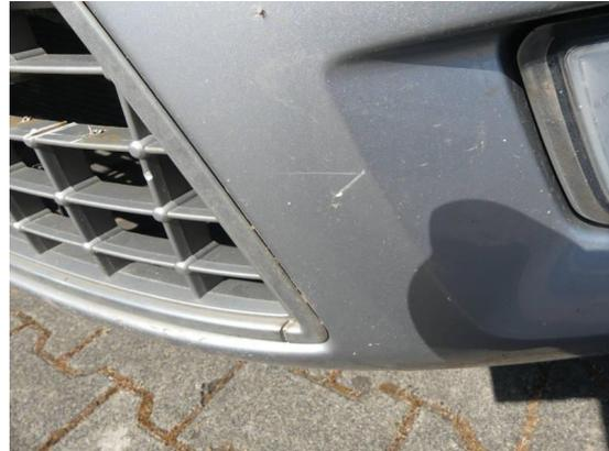
Bild 20: Karosserie / Stoßfänger vorn eingedrückt und zerkratzt
