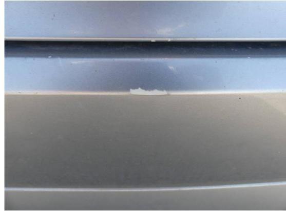
Bild 26: Karosserie / Stoßfänger hinten zerkratzt
