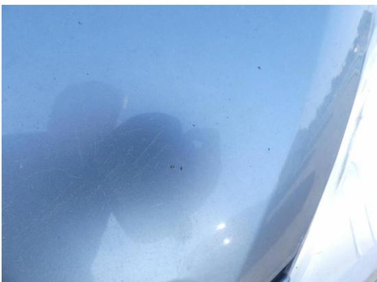
Bild 17: Karosserie / Motorhaube Steinschläge
