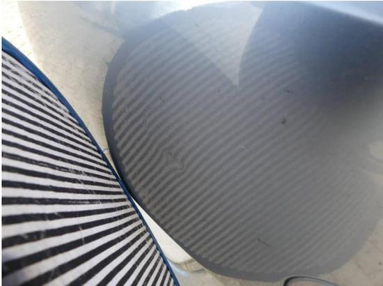
Bild 19: Karosserie / Stoßfänger vorn eingedrückt und zerkratzt
