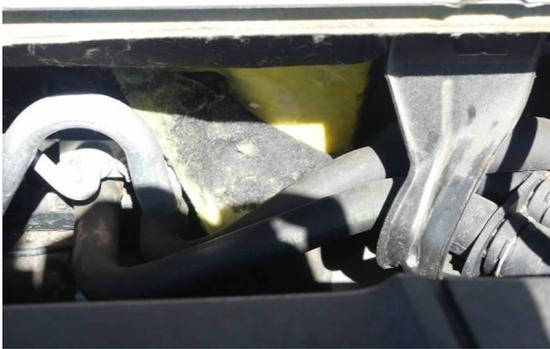
Bild 1: Technik / Dämmmatte Spritzwand zerrissen
