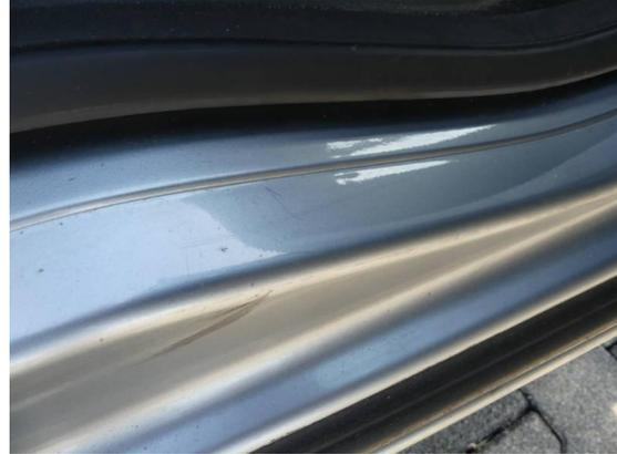
Bild 2: Karosserie / Einstieg hinten rechts zerkratzt
