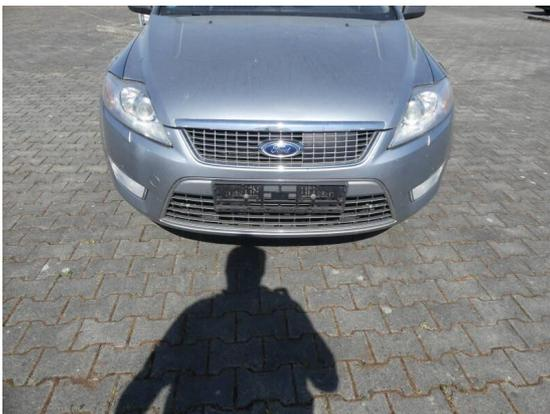
Bild 21: Karosserie / Stoßfänger vorn eingedrückt und zerkratzt
