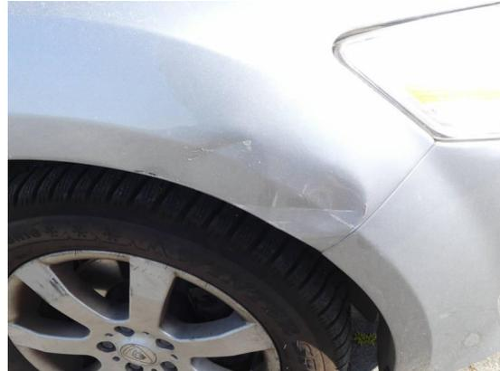
Bild 8: Karosserie / Kotflügel rechts deformiert und zerkratzt
