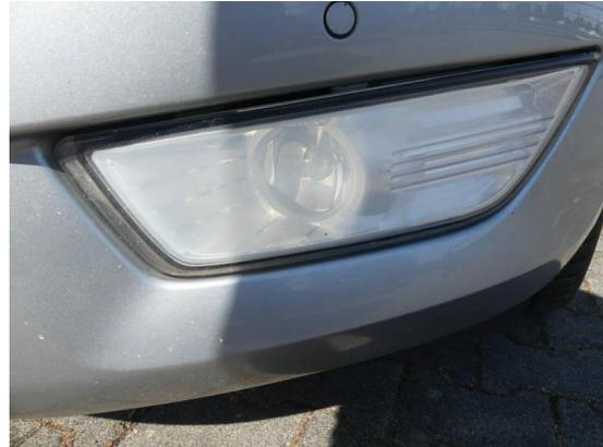
Bild 14: Technik / Nebelscheinwerfer rechts und links milchig
