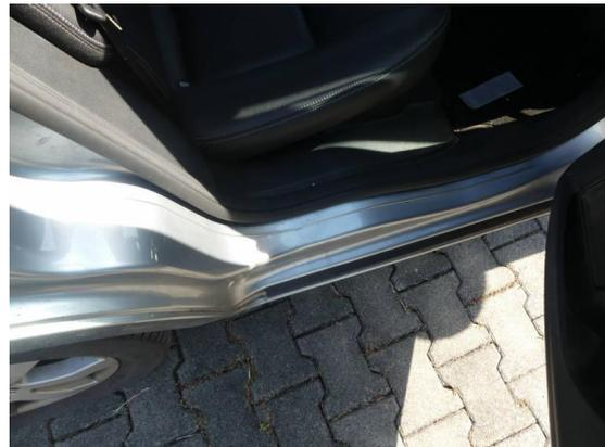
Bild 4: Karosserie / Einstieg hinten rechts zerkratzt
