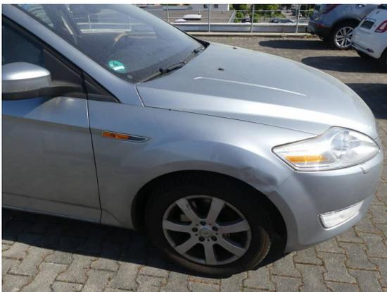
Bild 9: Karosserie / Kotflügel rechts deformiert und zerkratzt
