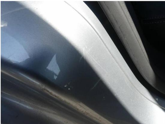
Bild 3: Karosserie / Einstieg hinten rechts zerkratzt
