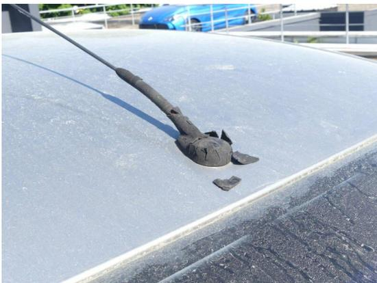
Bild 15: Technik / Antennenfuß Ummantlung blättert ab
