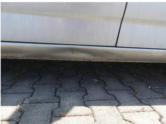
Bild 5: Karosserie / Schweller rechts eingedrückt
