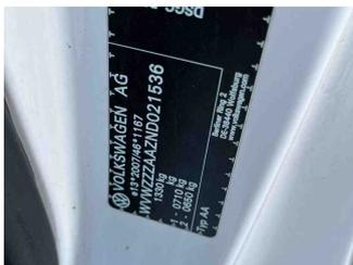
Fahrzeug - Typenschild/Fahrgestellnummer
