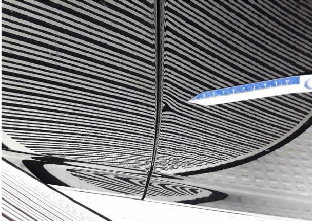
**Beschädigung #8:** Tür vorn rechts: Tür - Delle / Lackschaden -
