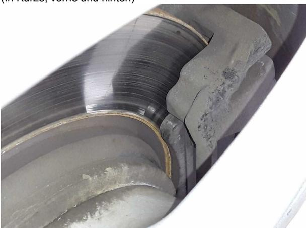
**Beschädigung #4:** Bremsanlage: Bremsscheiben und Beläge vorn
