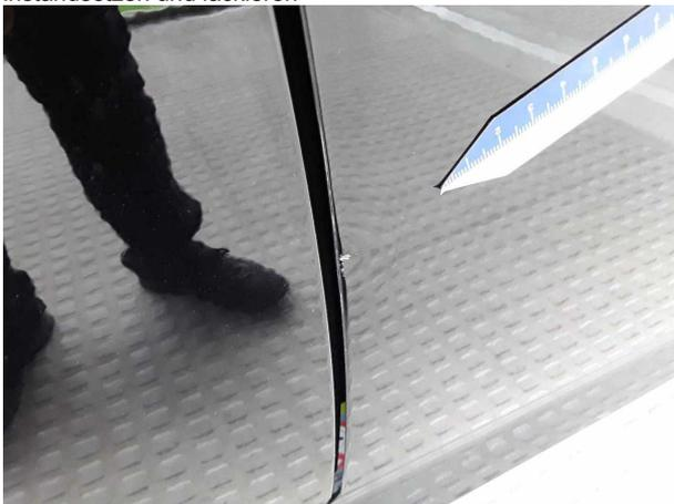
**Beschädigung #8:** Tür vorn rechts: Tür - Delle / Lackschaden -
