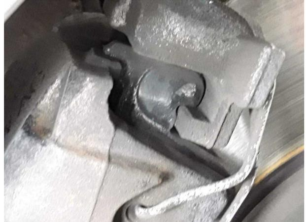
**Beschädigung #4:** Bremsanlage: Bremsscheiben und Beläge
