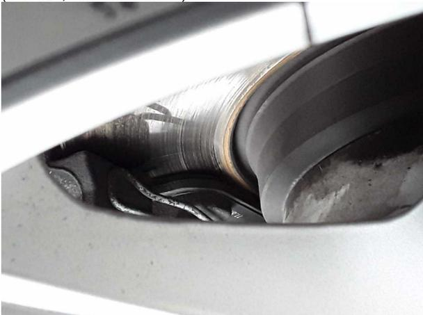
**Beschädigung #4:** Bremsanlage: Bremsscheiben und Beläge vorn
