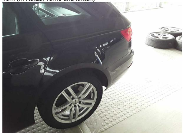
**Beschädigung #5:** Seitenwand links: Seitenwand - Delle /
