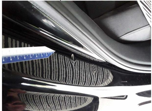
**Beschädigung #7:** Karosserie: C-Säule rechts - Delle / Lackschaden - Smart Repair
