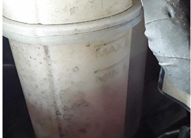
**Beschädigung #1:** Motorkühlung: Ausgleichsbehälter (Unter Minimal) - leer - befunden ggf. instandsetzen
