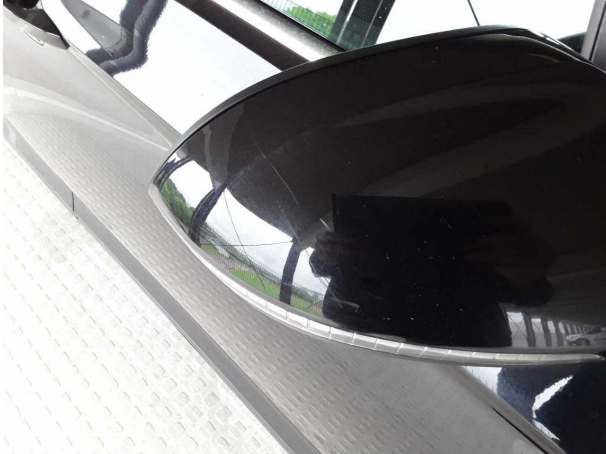
Beschädigung #8: Karosserie: Karosserie - Kratzer - auslegen / polieren
