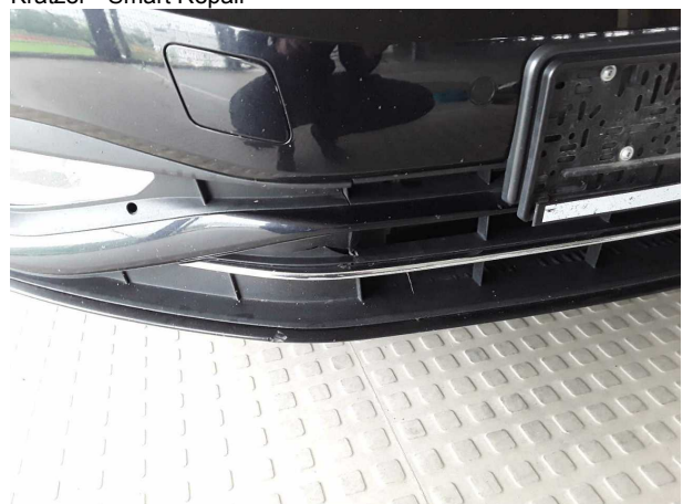
Beschädigung #3: Stossfänger vorn: Lufteinlassgitter - gebrochen / gerissen - erneuern
