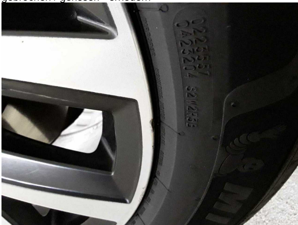
Beschädigung #4: Rad/Reifen: Leichtmetallfelge vorn links - Kratzer - Wertminderung
