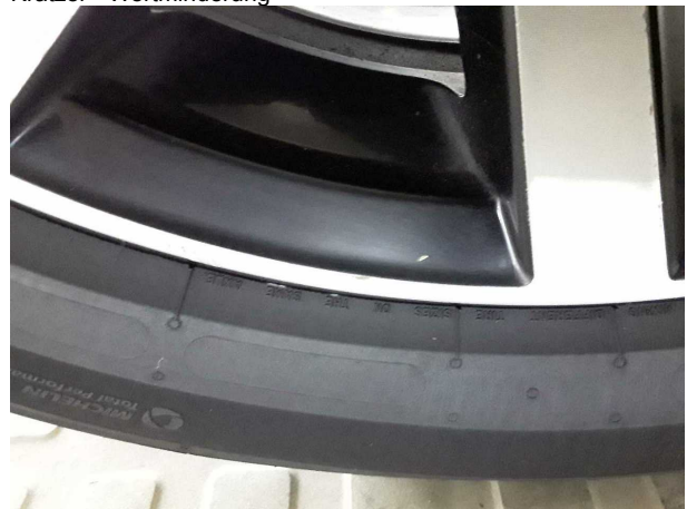
Beschädigung #4: Rad/Reifen: Leichtmetallfelge vorn links - Kratzer - Wertminderung
