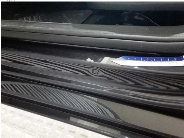
Beschädigung #6: Schweller links: Einstieg - Delle(n) - Smart Repair
