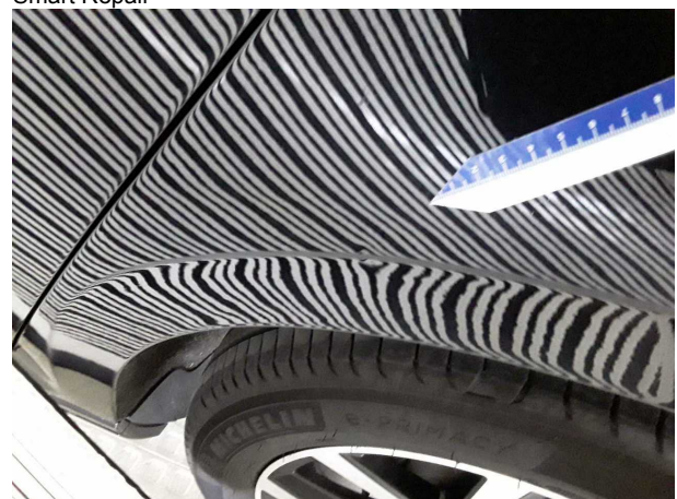
Beschädigung #7: Seitenwand links: Seitenwand - Kratzer - Smart Repair
