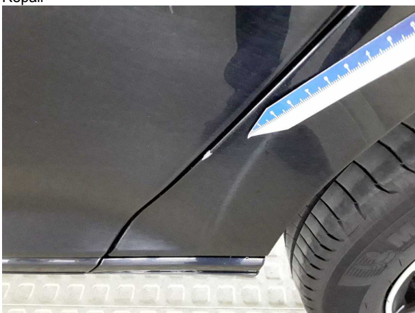
Beschädigung #7: Seitenwand links: Seitenwand - Kratzer - Smart Repair
