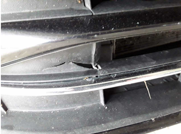
Beschädigung #3: Stossfänger vorn: Lufteinlassgitter - gebrochen / gerissen - erneuern
