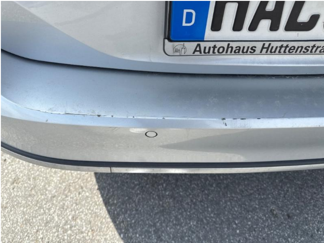
8. Stoßfänger hinten - Verkratzt
