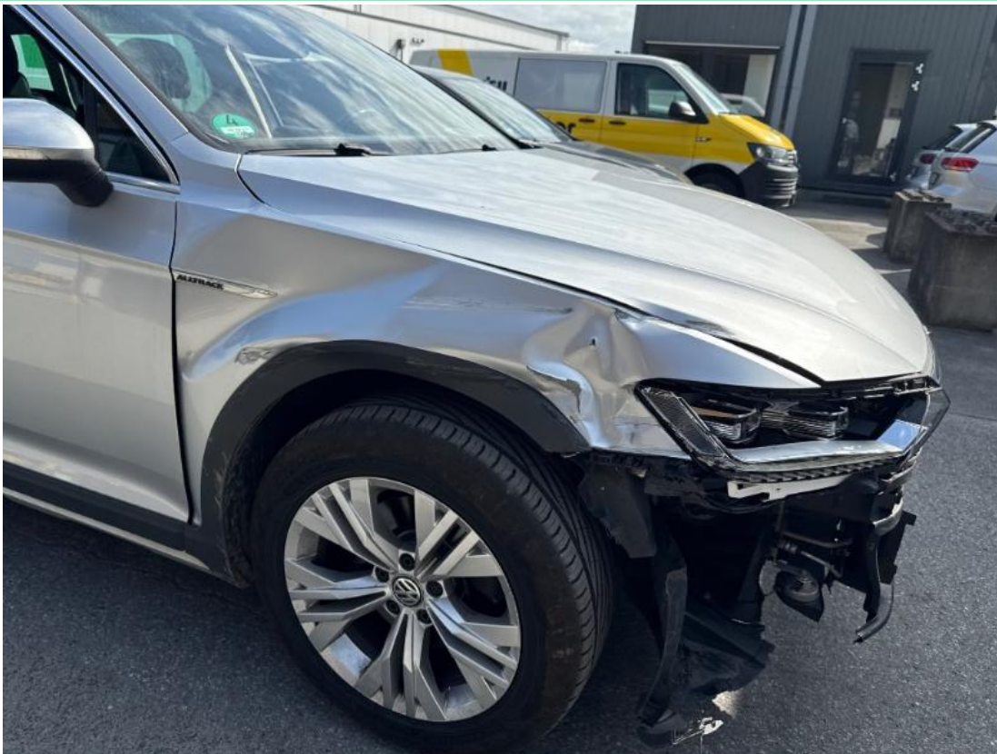
12. Kotflügel vorne rechts - Verformt
