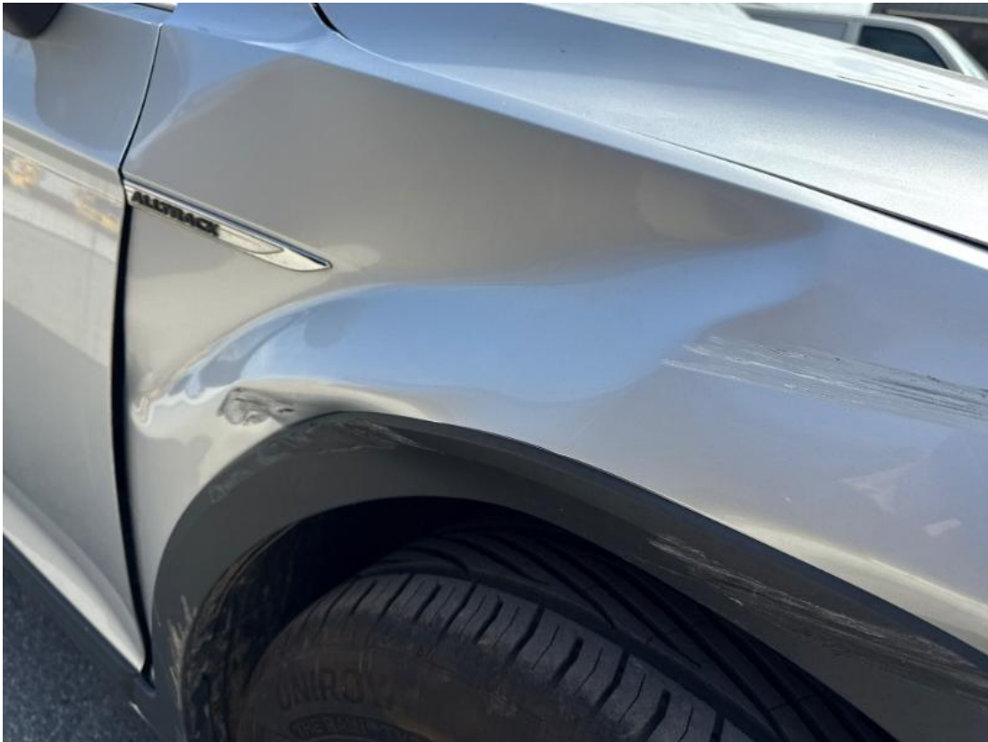
12. Kotflügel vorne rechts - Verformt
