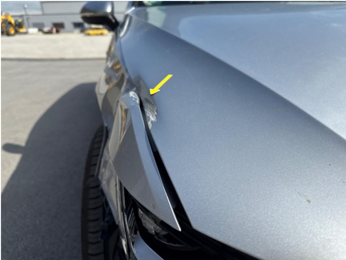
11. Motorhaube - Delle + Steinschlag
