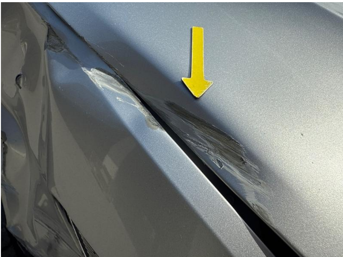
11. Motorhaube - Delle + Steinschlag
