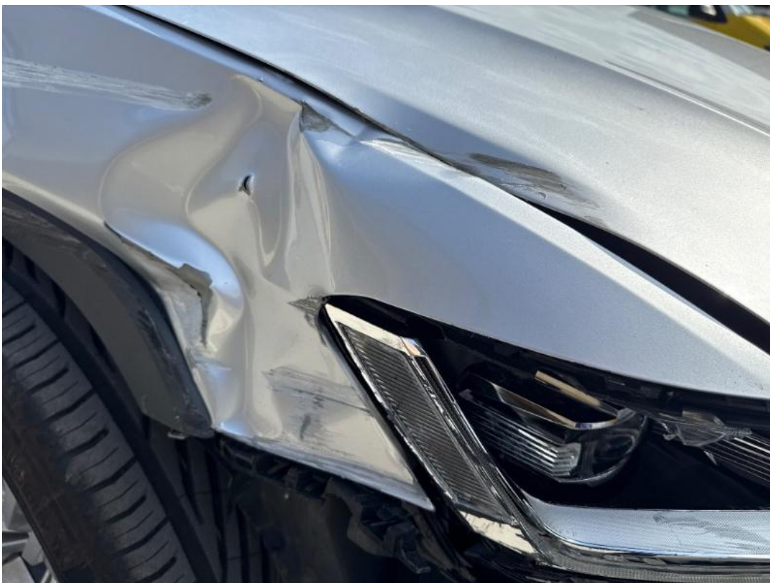
12. Kotflügel vorne rechts - Verformt
