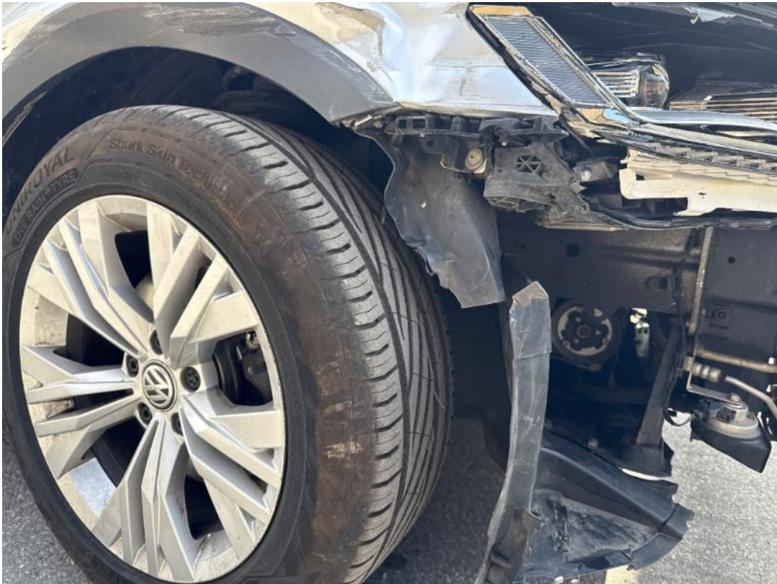
7. Radhausschale vorne rechts - Gerissen
