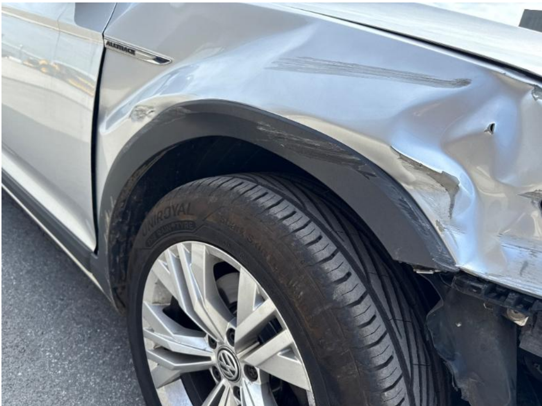
6. Blende Radlauf vorne rechts - Verformt
