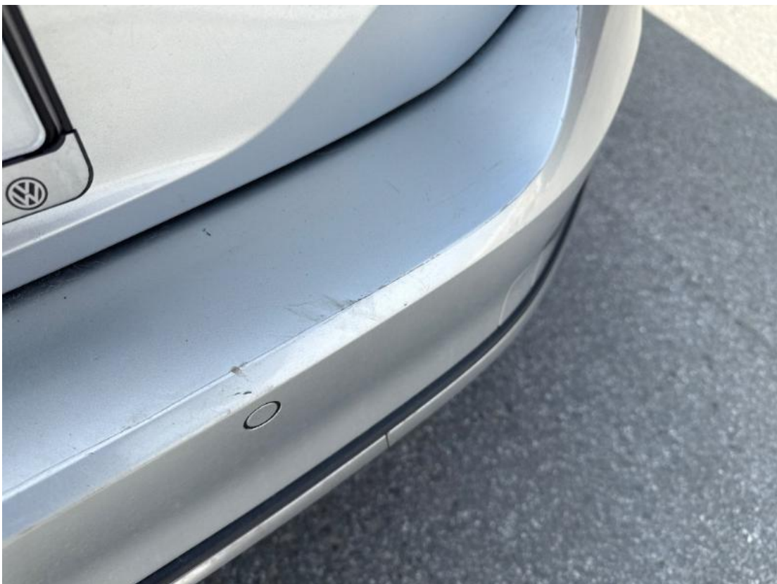
8. Stoßfänger hinten - Verkratzt
