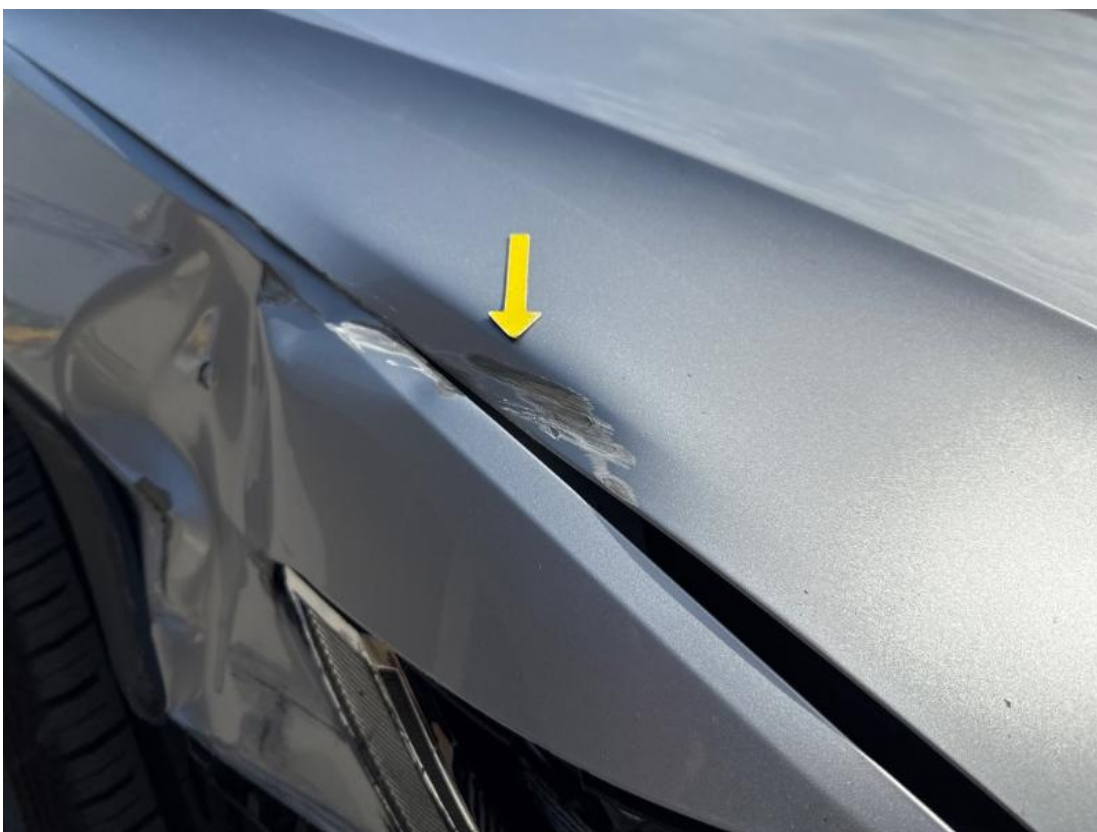
11. Motorhaube - Delle + Steinschlag
