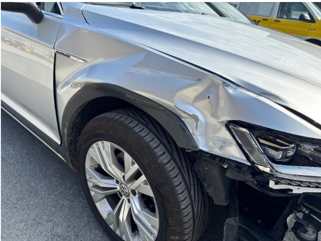
12. Kotflügel vorne rechts - Verformt
