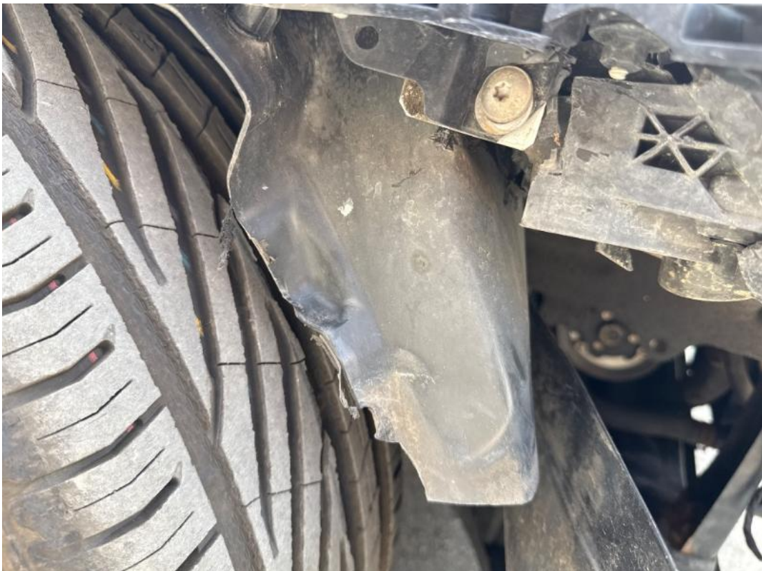
7. Radhausschale vorne rechts - Gerissen
