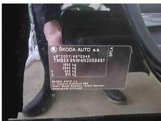
Fahrzeug - Typenschild/Fahrgestellnummer
