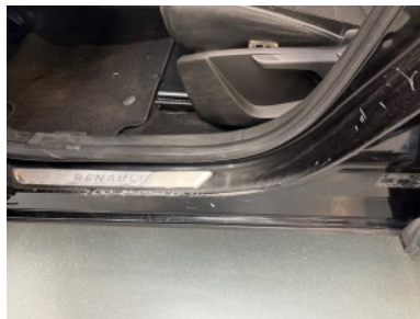
Bestuurderstoel beschadigd+Instapschade bestuurderkant+Brandgaten passagierstoel+stuurwiel versleten
