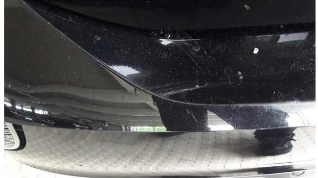
**Beschädigung #14:** Stossfänger hinten: Stossfänger hinten - Kratzer - instandsetzen und lackieren
