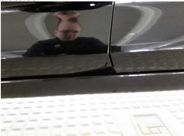
**Beschädigung #18:** Tür vorn links: Tür - verformt - instandsetzen und lackieren
