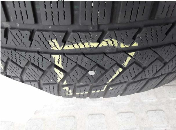
**Beschädigung #5:** 2.Radsatz: 2 Reifen - beschädigt - erneuern
