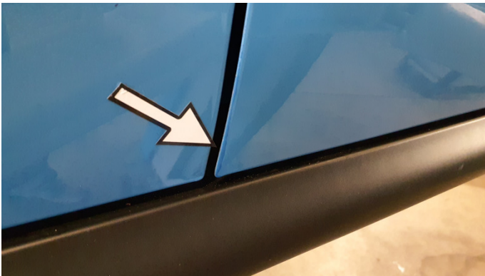
7. Tür Vorne - Rechts Unsachgemäß Instandgesetzt -
