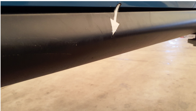
23. Verkleidung Seitenschweller links Kratzer -
