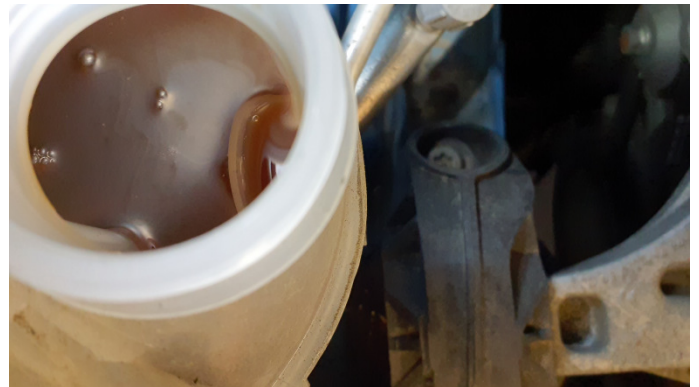
18. Ausgleichsbehälter Kühlwasser Verschmutzt (stark) -
