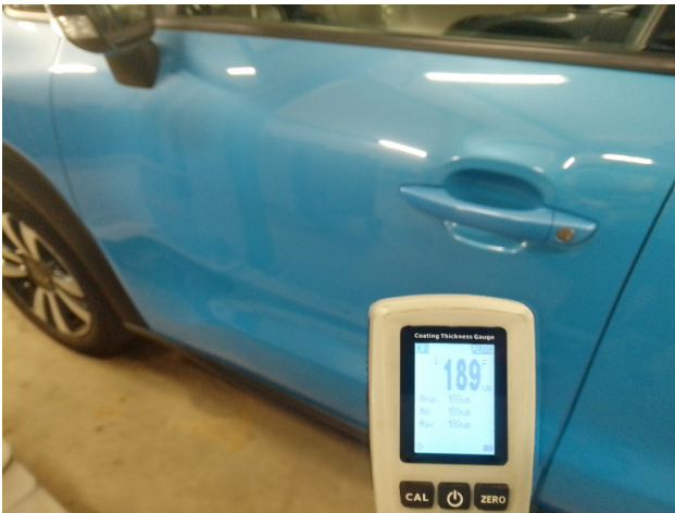
11. Tür Vorne - Links Nachlackiert - Ohne Reparatur
