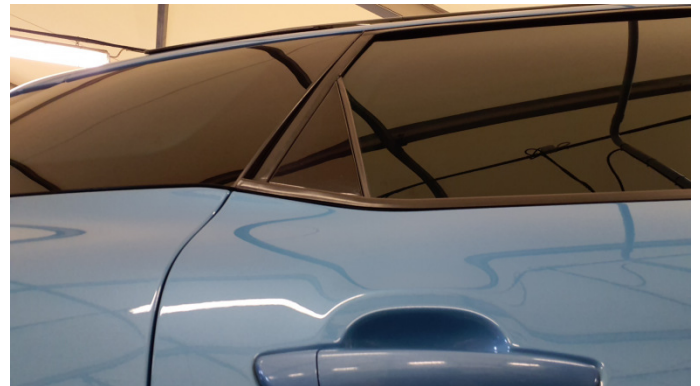
25. Fensterschachtleiste hinten rechts Verformt -
