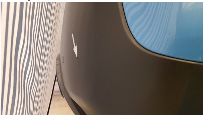
4. Stoßfänger Hinten 1 Delle -
