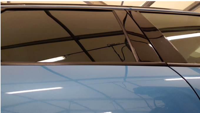
25. Fensterschachtleiste hinten rechts Verformt -
