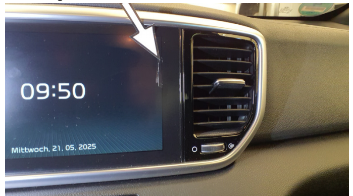
15. Display Infotainment Displayschaden -
