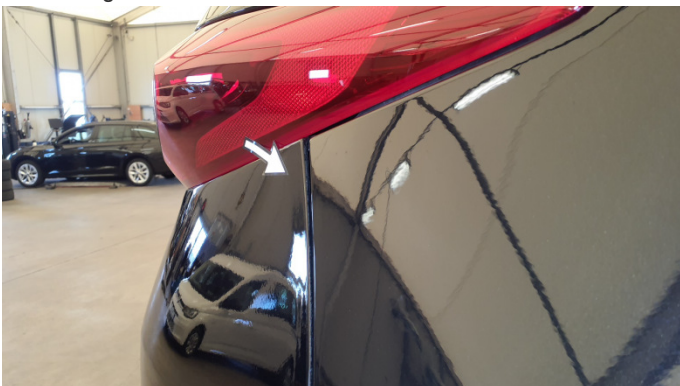
5. Stoßfänger Hinten Spaltmaß Ungenau -
