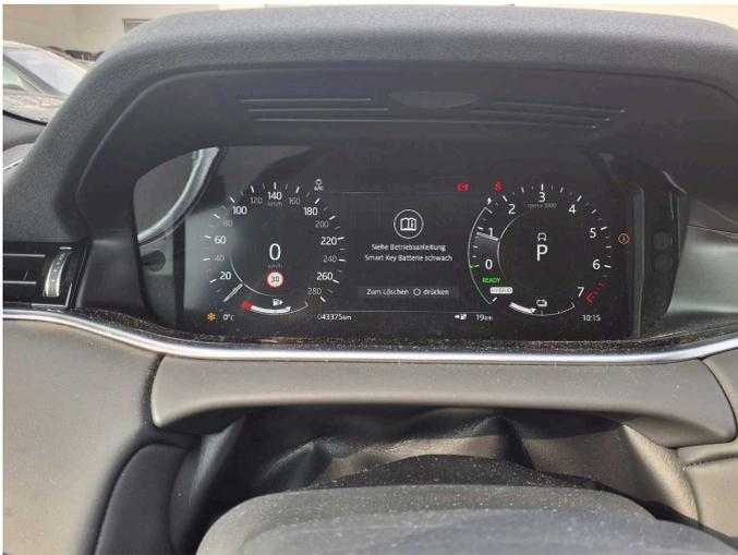
Abbildung 9: Kombiinstrument
