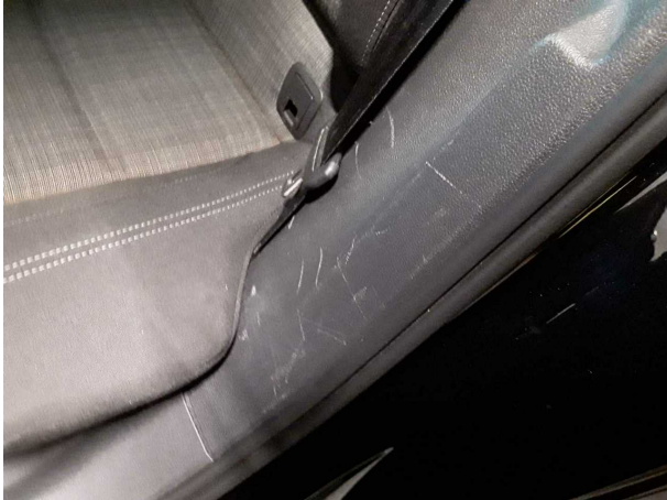
Beschädigung #8: Karosserie: C-Säule links - Kratzer - Smart Repair
