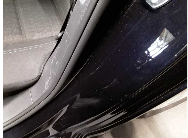
Beschädigung #8: Karosserie: C-Säule links - Kratzer - Smart Repair
