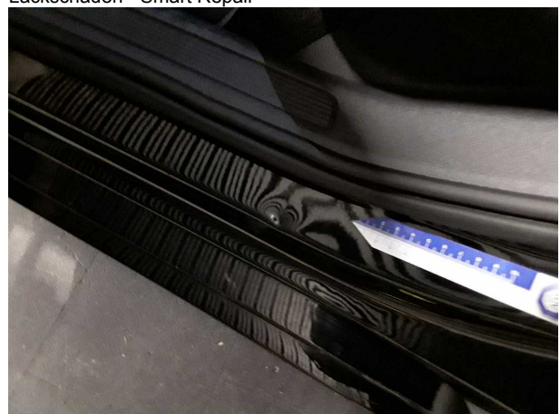
Beschädigung #9: Seitenwand links: Einstieg - Delle / Lackschaden - Smart Repair
