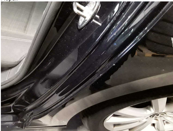
Beschädigung #8: Karosserie: C-Säule links - Kratzer - Smart Repair
