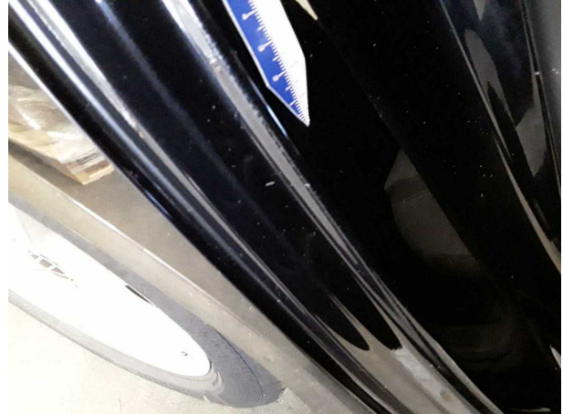
Beschädigung #6: Karosserie: C-Säule rechts - Kratzer - Smart Repair
