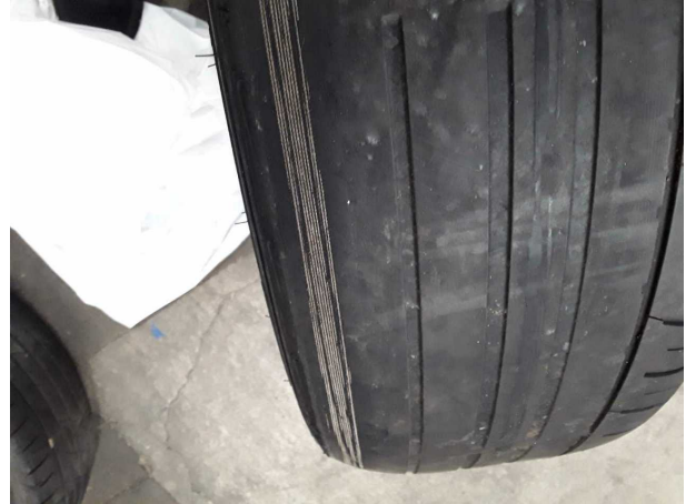
Beschädigung #3: 2.Radsatz: 2 Reifen - verschlissen - erneuern
