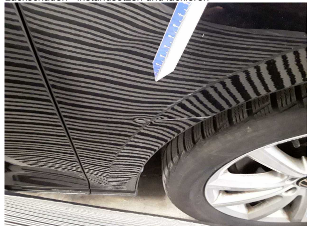
Beschädigung #10: Kotflügel rechts: Kotflügel rechts - Delle / Lackschaden - instandsetzen und lackieren
