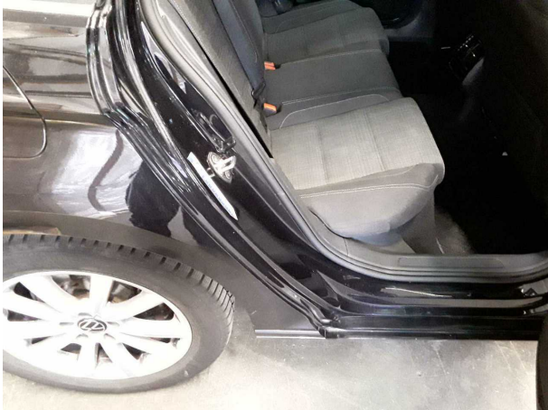
Beschädigung #6: Karosserie: C-Säule rechts - Kratzer - Smart Repair
