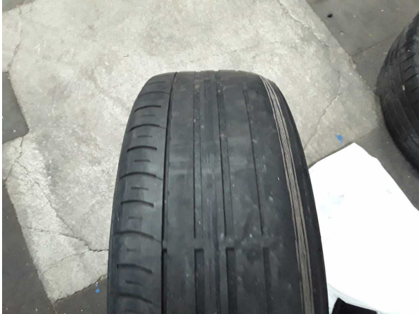
Beschädigung #3: 2.Radsatz: 2 Reifen - verschlissen - erneuern
