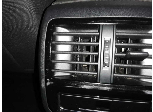
Beschädigung #1: Instrumententafel: Luftdüse Mitte - gebrochen / gerissen - erneuern
