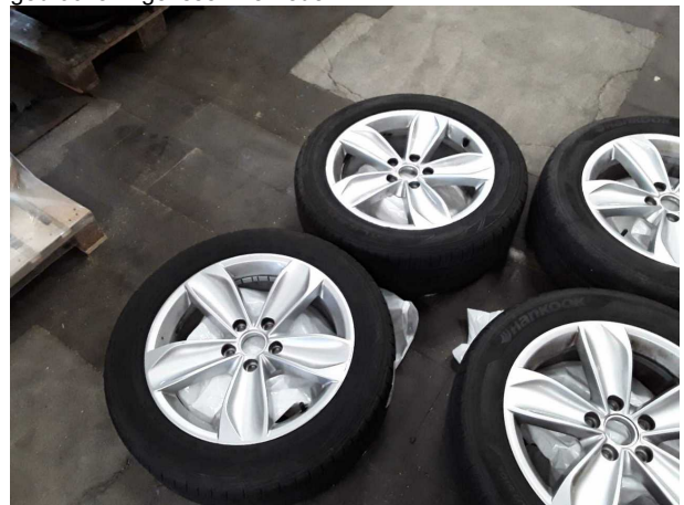
Beschädigung #3: 2.Radsatz: 2 Reifen - verschlissen - erneuern
