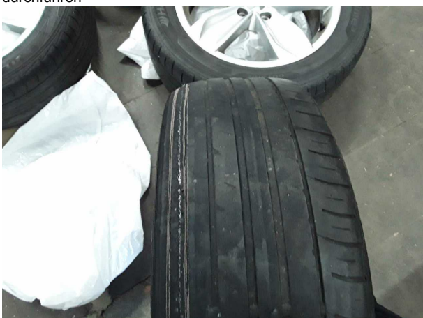
Beschädigung #3: 2.Radsatz: 2 Reifen - verschlissen - erneuern
