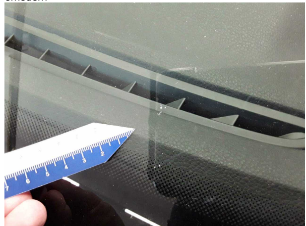
Beschädigung #5: Verglasung: Frontscheibe - gebrochen / gerissen - erneuern
