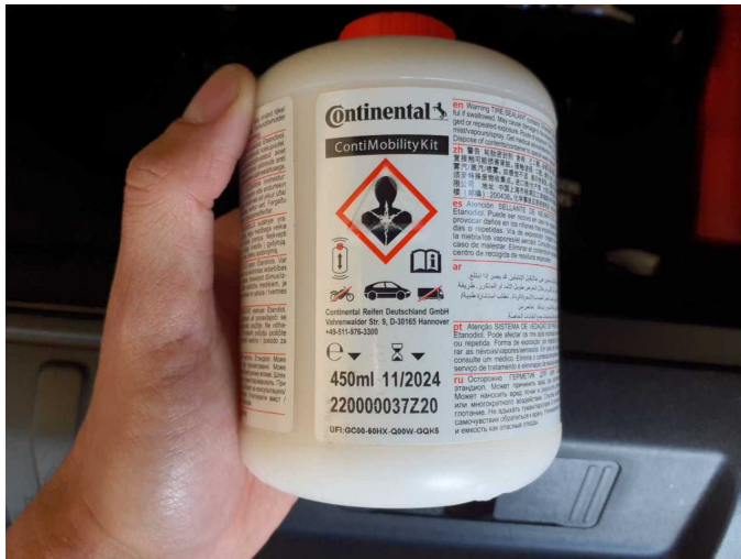
Beschädigung 1: Ausrüstung: Tirefit Füllmittel - abgelaufen - erneuern
