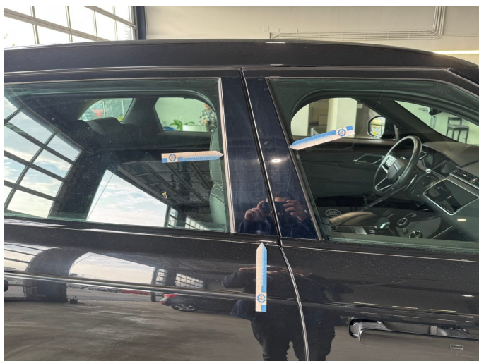
Beschädigung 7: Verkleidungen/Abdeckungen: B-Säule rechts Verkleidung innen - verkratzt / verschürft - auslegen / polieren
