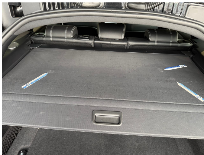
Beschädigung 3: Interieur: Laderaumabdeckung / Rollo - verschmutzt - reinigen
