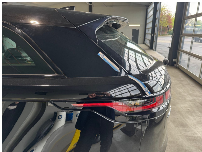
Beschädigung 2: Karosserie: D-Säule links - Kratzer - auslegen / polieren
