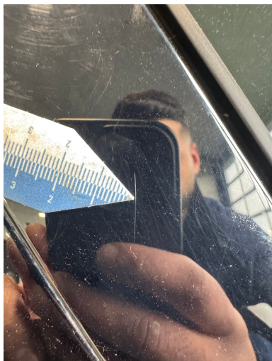
Beschädigung 1: Karosserie: C-Säule links - Kratzer - auslegen / polieren
