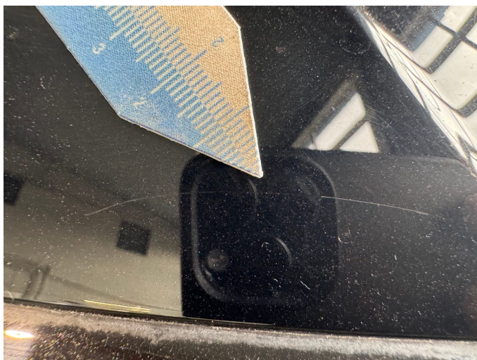
Beschädigung 2: Karosserie: D-Säule links - Kratzer - auslegen / polieren
