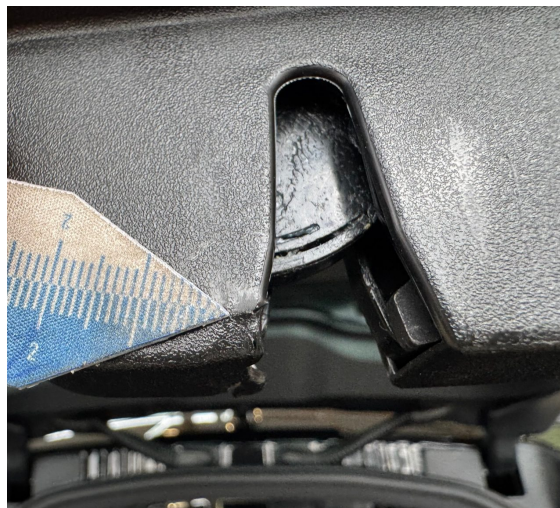
Beschädigung 11: Heckklappe/-tür: Heckklappe - Funktion / Zulässigkeit - einstellen/justieren
