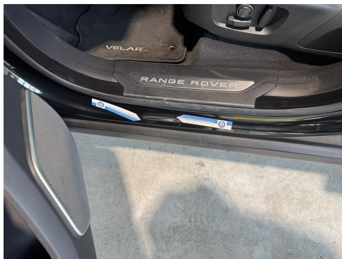
Beschädigung 4: Schweller links: Einstieg - Kratzer - auslegen / polieren
