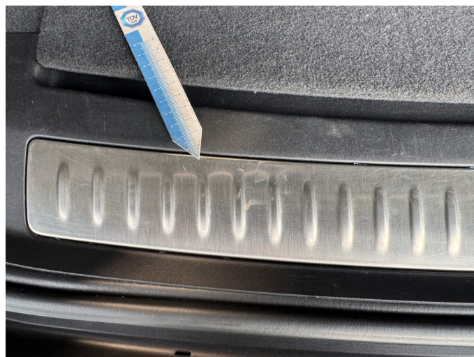
Gebrauchsspur 3: Verkleidungen/Abdeckungen: Verkleidung Ladekante - Kratzer - kein Abzug
