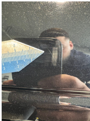
Beschädigung 6: Tür vorn links: Tür - Kratzer - auslegen / polieren
