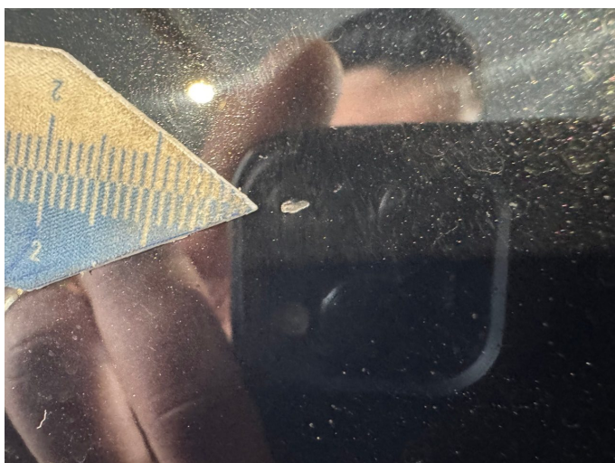
Beschädigung 10: Stossfänger vorn: Stossfänger vorn rechts - Steinschlag - auslegen / polieren
