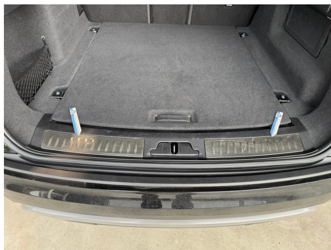
Gebrauchsspur 3: Verkleidungen/Abdeckungen: Verkleidung Ladekante - Kratzer - kein Abzug
