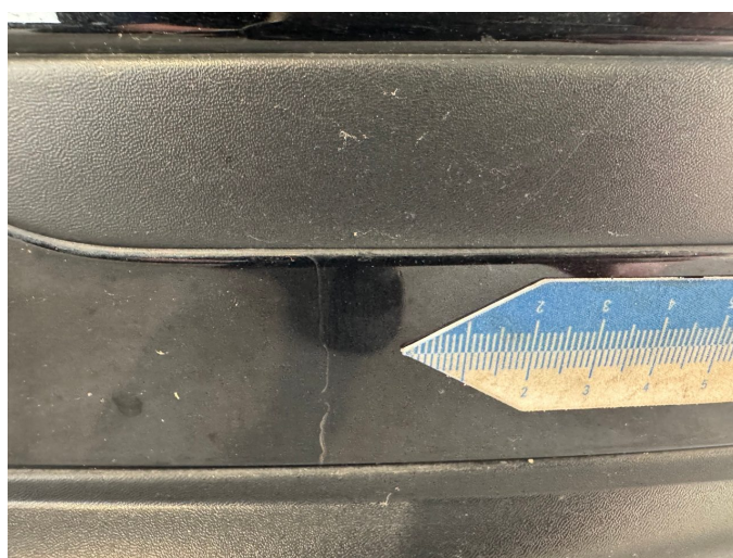
Beschädigung 5: Stossfänger vorn: Spoiler - Kratzer - auslegen / polieren
