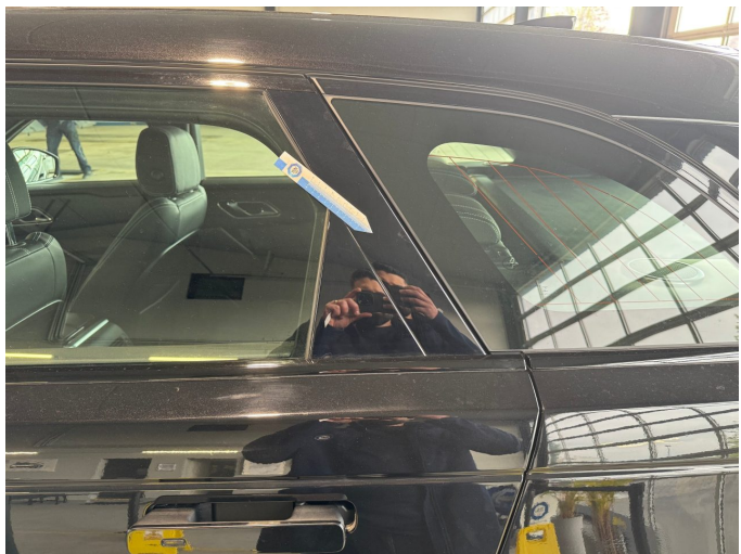
Beschädigung 1: Karosserie: C-Säule links - Kratzer - auslegen / polieren
