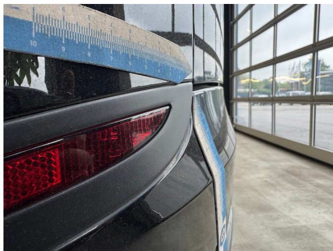
Beschädigung 11: Heckklappe/-tür: Heckklappe - Funktion / Zulässigkeit - einstellen/justieren
