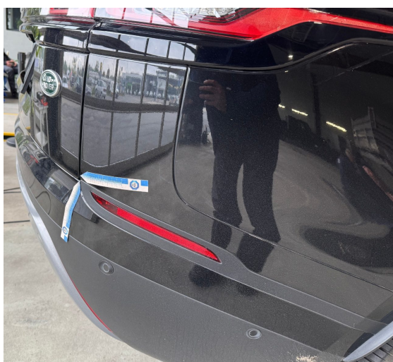
Beschädigung 11: Heckklappe/-tür: Heckklappe - Funktion / Zulässigkeit - einstellen/justieren
