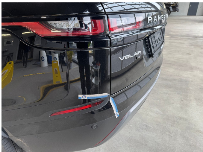
Beschädigung 11: Heckklappe/-tür: Heckklappe - Funktion / Zulässigkeit - einstellen/justieren
