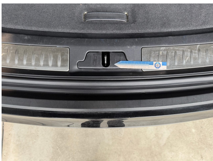
Beschädigung 11: Heckklappe/-tür: Heckklappe - Funktion / Zulässigkeit - einstellen/justieren
