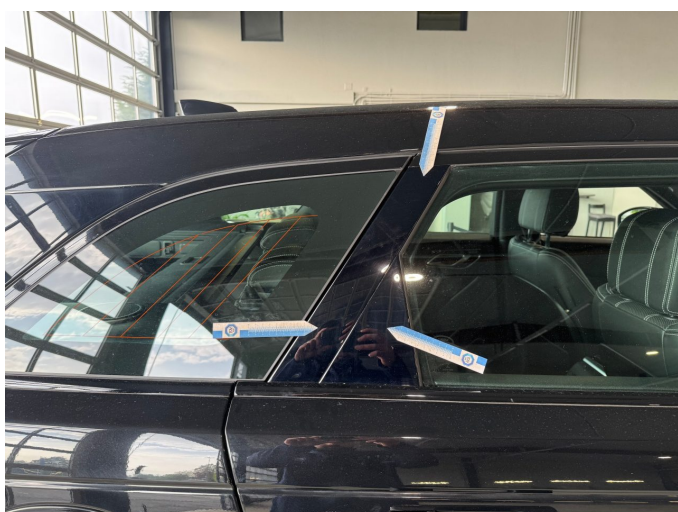
Beschädigung 8: Verkleidungen/Abdeckungen: C-Säule rechts Verkleidung innen - verkratzt / verschürft - auslegen / polieren
