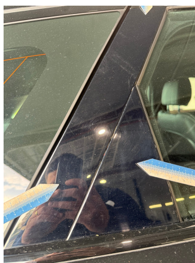
Beschädigung 8: Verkleidungen/Abdeckungen: C-Säule rechts Verkleidung innen - verkratzt / verschürft - auslegen / polieren
