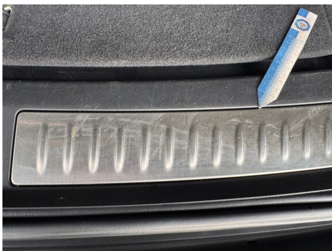
Gebrauchsspur 3: Verkleidungen/Abdeckungen: Verkleidung Ladekante - Kratzer - kein Abzug
