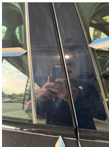
Beschädigung 7: Verkleidungen/Abdeckungen: B-Säule rechts Verkleidung innen - verkratzt / verschürft - auslegen / polieren
