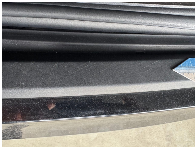
Gebrauchsspur 4: Stossfänger hinten: Schutzleiste Mitte - verkratzt / verschürft - kein Abzug
