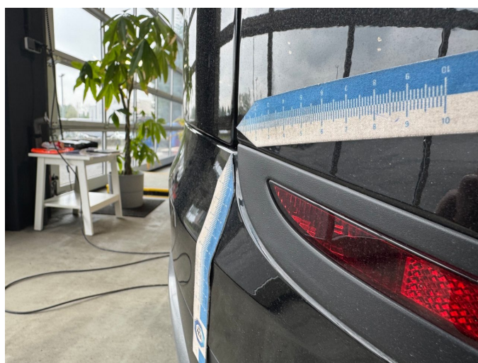
Beschädigung 11: Heckklappe/-tür: Heckklappe - Funktion / Zulässigkeit - einstellen/justieren
