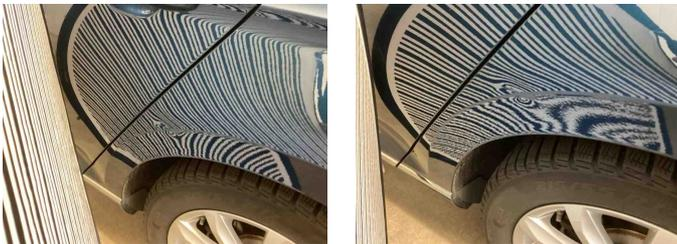
3 - Tür hinten rechts - Delle(n) und Kratzer - Instandsetzen + lackieren
