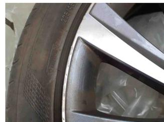
2 - Zusätzliche Felge(n) Glanzgedreht - Deformiert - Ersetzen
