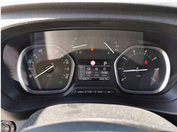
Abbildung 5: Kombiinstrument
