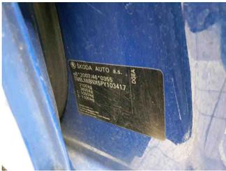
Fahrzeug - Typenschild/Fahrgestellnummer
