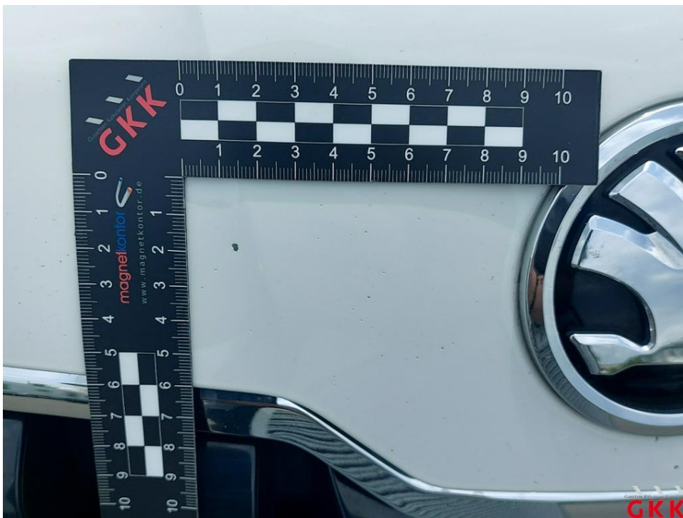
Bild 28 Motorhaube, Steinschlag, auslegen, schleifen, polieren
