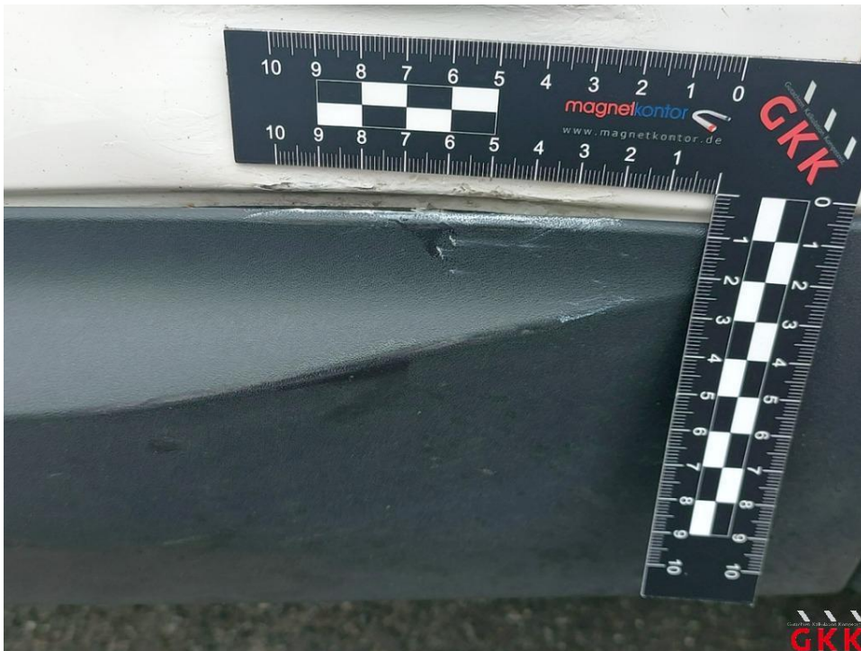
Bild 24 Tür vorne rechts, Leiste unten -unlackiert-, beschädigt, ersetzen
