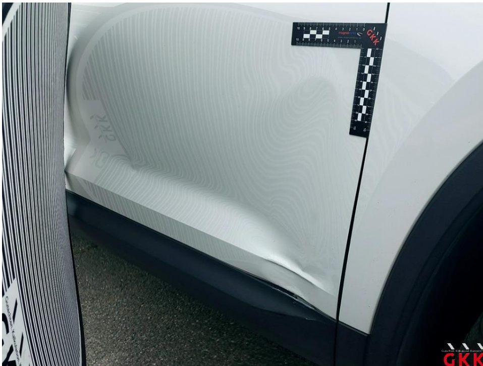
Bild 22 Tür vorne rechts, beschädigt, ersetzen
