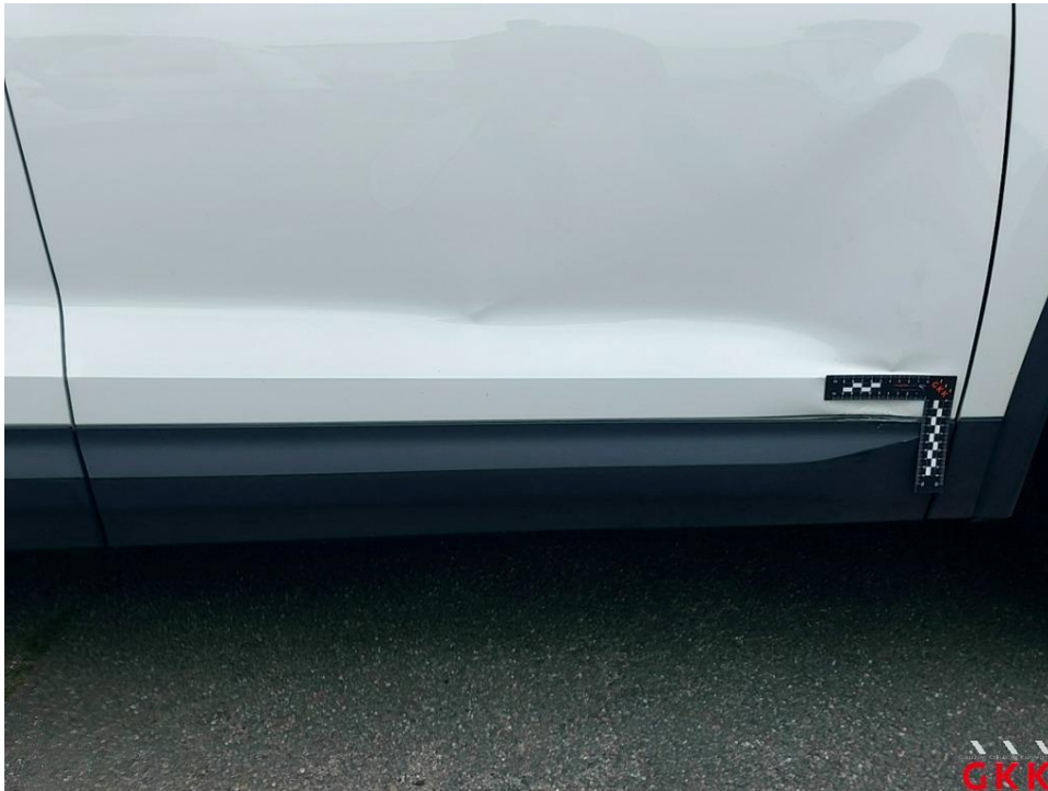
Bild 23 Tür vorne rechts, Leiste unten -unlackiert-, beschädigt, ersetzen
