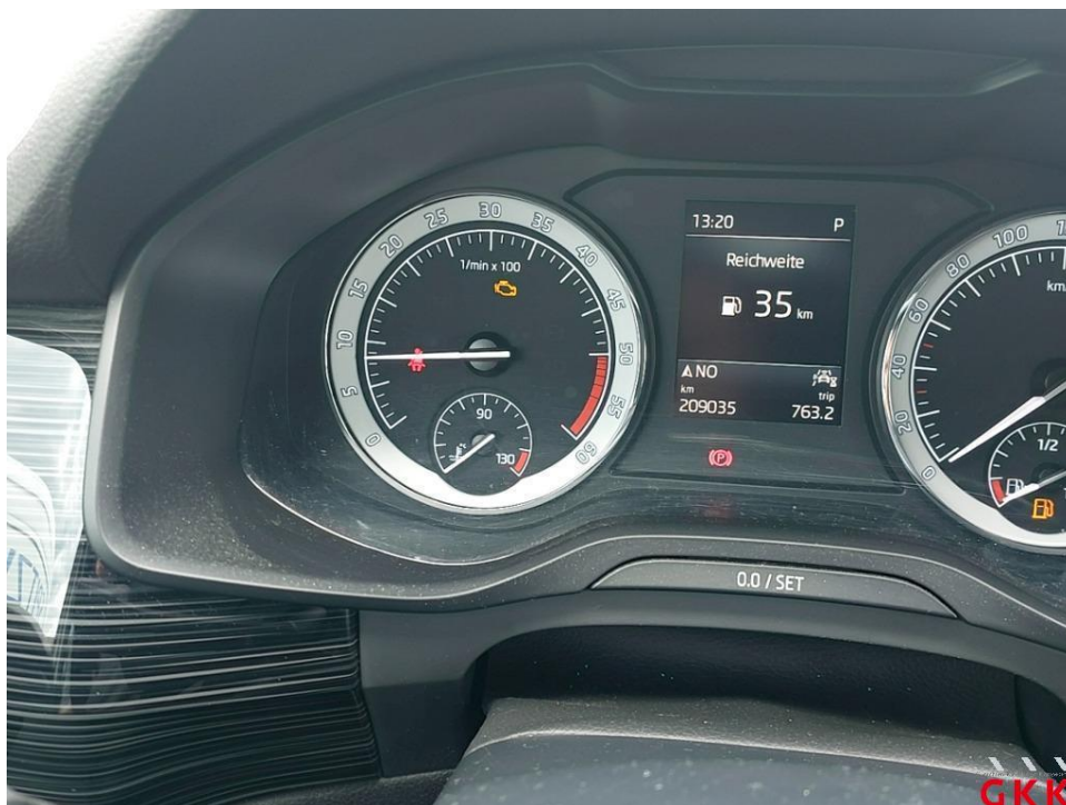
Bild 16 Motor, Motorkontrollleuchte, aktiv, prüfen
