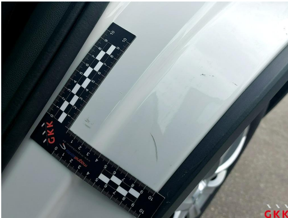
Bild 34 C- Säule links, verkratzt, lackieren
