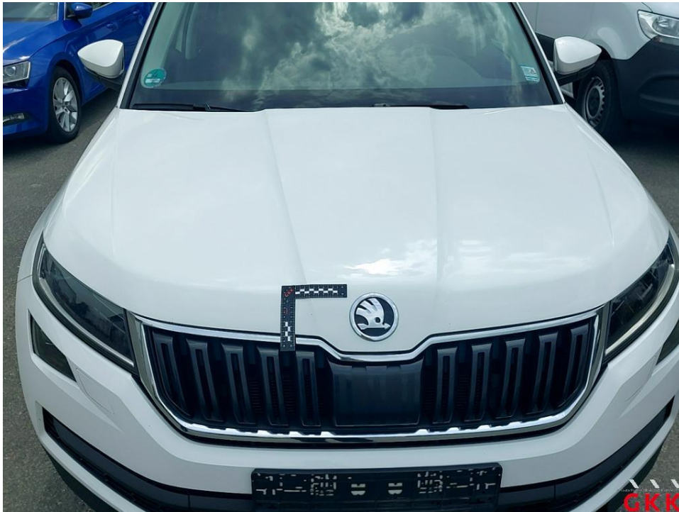
Bild 27 Motorhaube, Steinschlag, auslegen, schleifen, polieren
