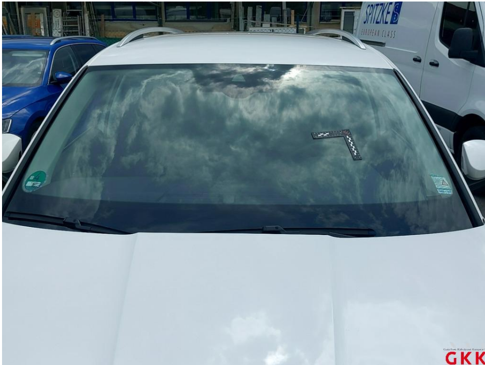
Bild 35 Frontscheibe, mit Regensensor und Frontkamera, Steinschlag im Sichtfeld, ersetzen
