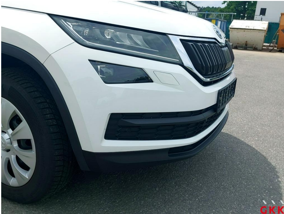
Bild 29 Stoßfänger vorne, Verkleidung -lackiert-, Reparaturmangel, lackieren
