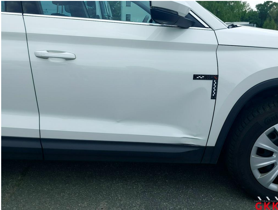
Bild 21 Tür vorne rechts, beschädigt, ersetzen
