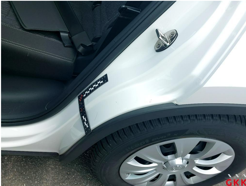
Bild 33 C- Säule links, verkratzt, lackieren
