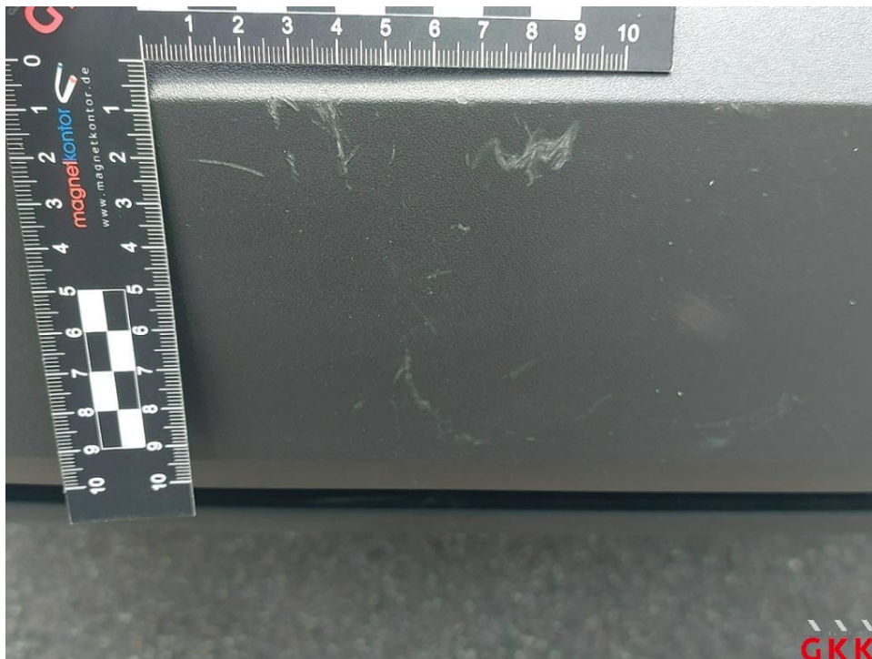
Bild 32 Stoßfänger hinten, Verkleidung unterhalb -unlackiert-, verkratzt, Smartrepair
