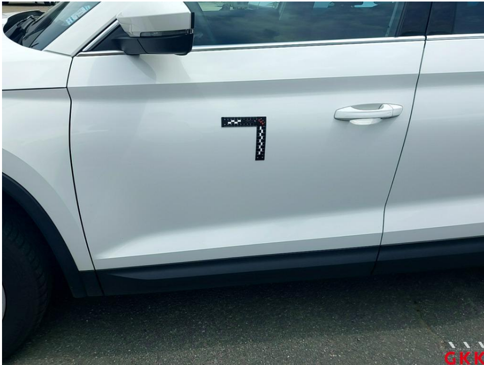
Bild 37 Tür vorne links, beschädigt, kalt drücken
