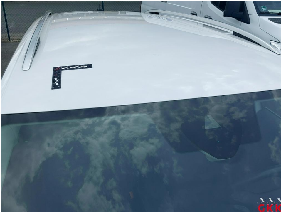
Bild 19 Dach, beschädigt, kalt drücken
