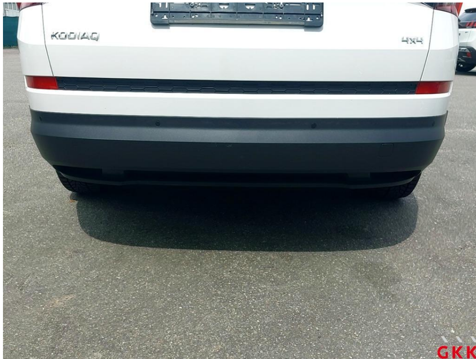
Bild 31 Stoßfänger hinten, Verkleidung unterhalb -unlackiert-, verkratzt, Smartrepair
