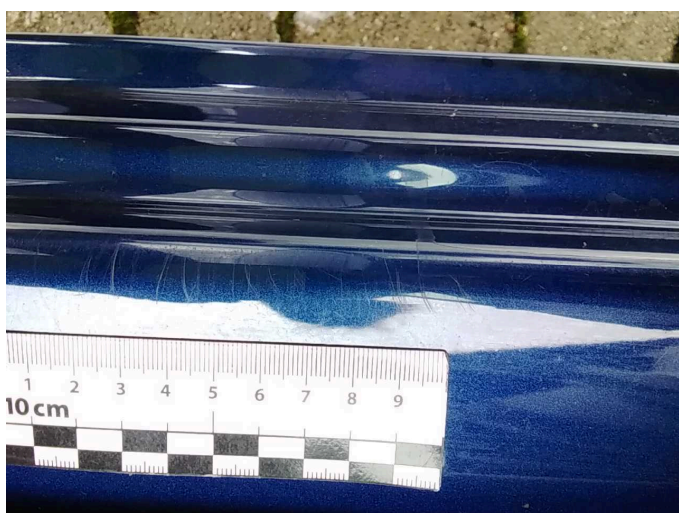
Beschädigung 6: Schweller links: Einstieg - Kratzer - Smart Repair
