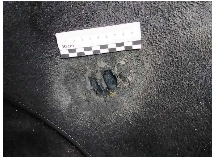
Beschädigung 1: Verkleidungen/Abdeckungen: Fußmatten (Fußmatte vorne links) - beschädigt - erneuern
