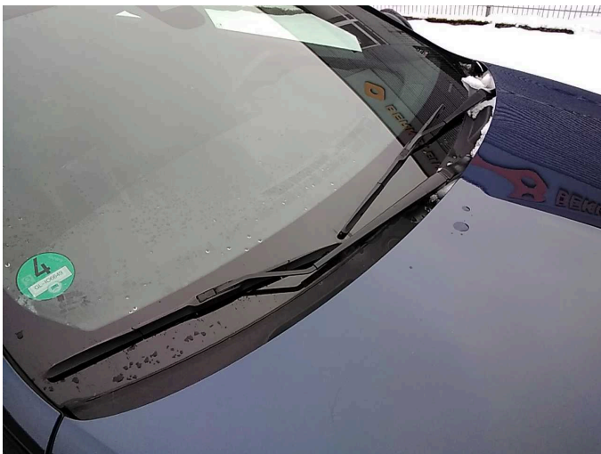
Beschädigung 2: Scheibenreinigung: Scheibenwischerblätter vorn - beschädigt - erneuern
