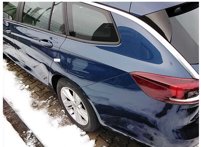
Beschädigung 3: Seitenwand links: Seitenwand - Delle / Lackschaden - sanft instandsetzen
