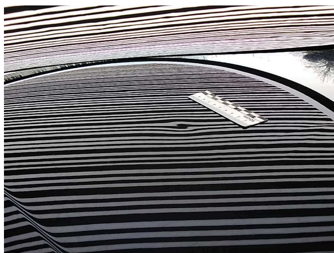
Beschädigung 7: Fahrzeugdach: Dach (3 Dellen) - Delle(n) - sanft instandsetzen
