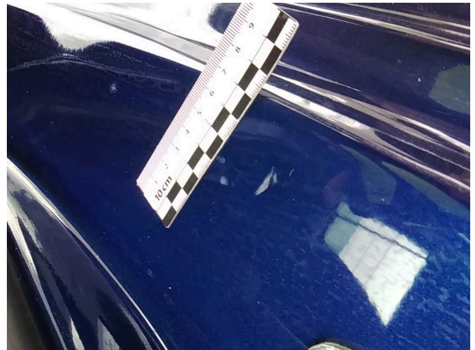
Beschädigung 8: Seitenwand rechts: Einstieg - Delle / Lackschaden - instandsetzen und lackieren
