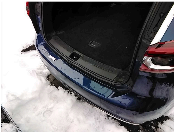
Beschädigung 10: Stossfänger hinten: Stossfänger mit Parktronic - verkratzt / verschürft - instandsetzen und lackieren
