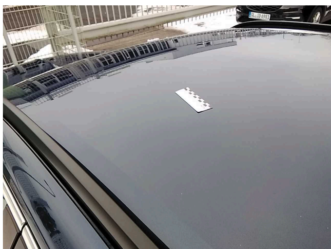
Beschädigung 7: Fahrzeugdach: Dach (3 Dellen) - Delle(n) - sanft instandsetzen
