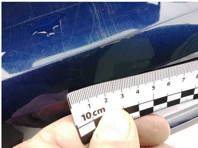
Beschädigung 10: Stossfänger hinten: Stossfänger mit Parktronic - verkratzt / verschürft - instandsetzen und lackieren
