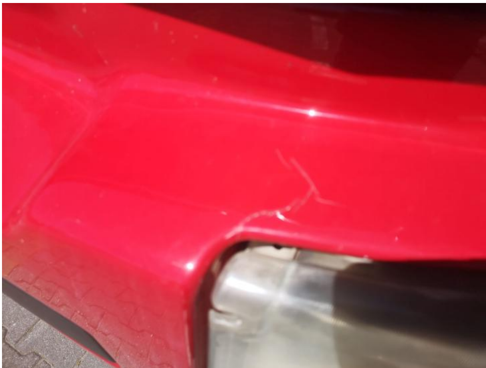
Fot. 77. PRZ - pęknięcie 1
