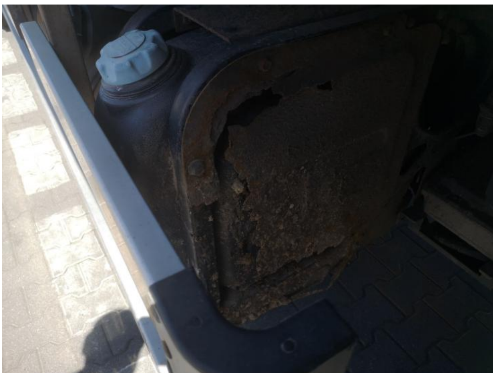
Fot. 78. P - korozja 1
