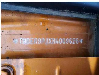
Fahrzeug - Typenschild/Fahrgestellnummer
